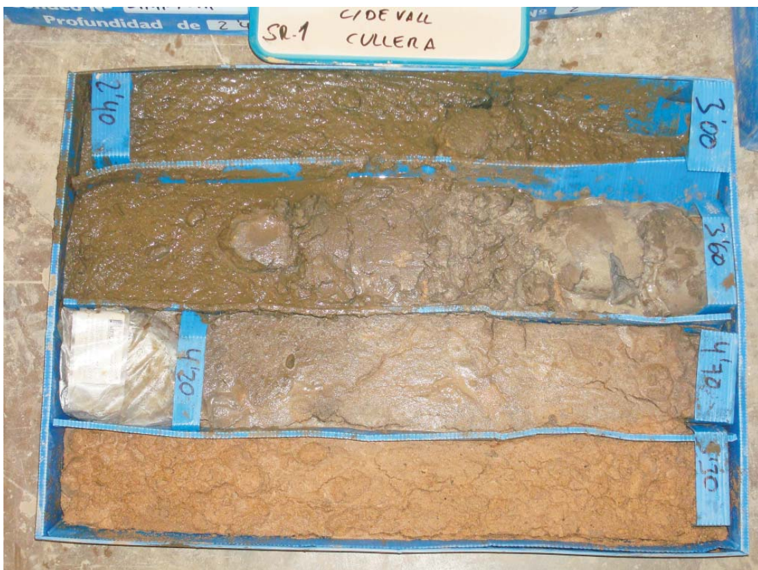
SONDEO 1. TESTIGO DE MUESTRA ENTRE 0,0 Y 5,3 M DE PROFUNDIDAD
