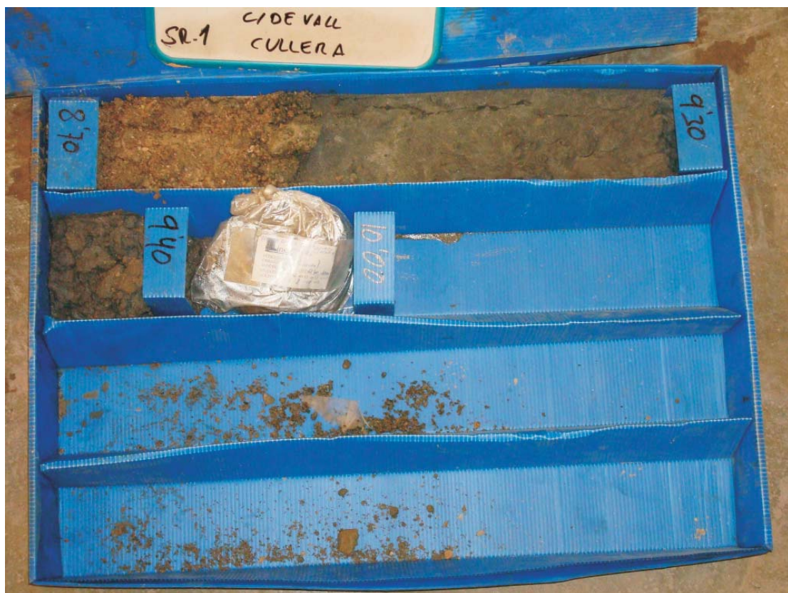
SONDEO 1. TESTIGO DE MUESTRA ENTRE 5,3 Y 10 M DE PROFUNDIDAD
