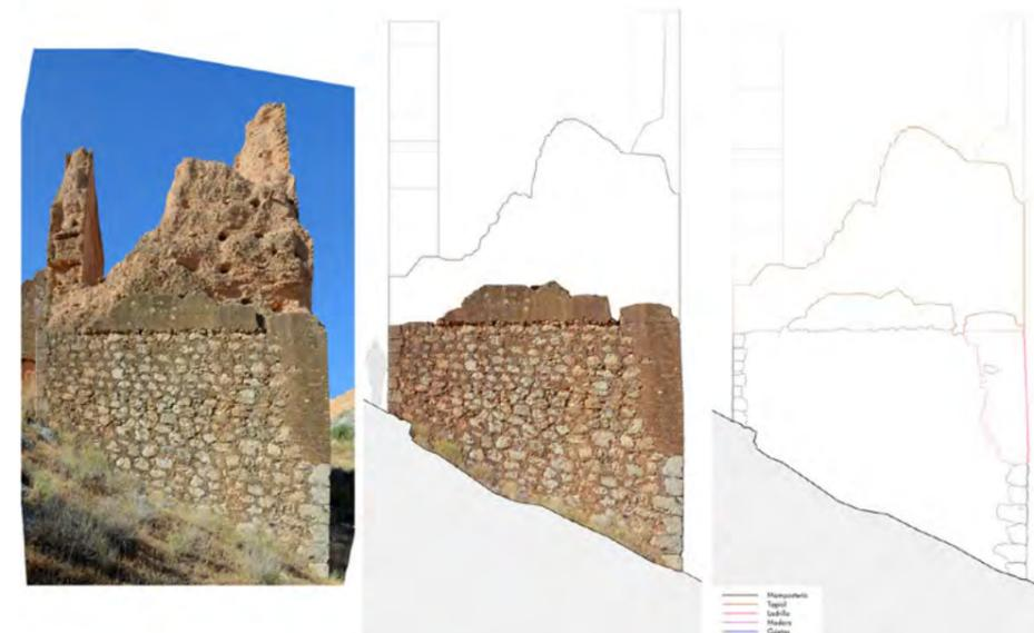
Alzado fotogramétrico. Torre de entrada, muro norte, cara exterior.
