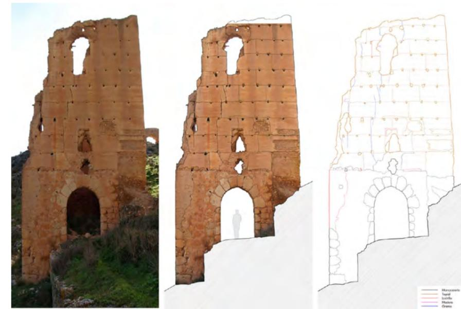
Alzado fotogramétrico. Torre de entrada, muro oeste, cara exterior.
