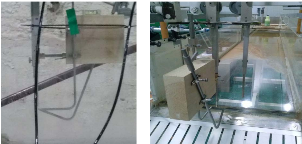
Figura 3.15. Vista de los dispositivos tipo Pitot en posición horizontal y 22° dispuestos en paralelo para poder realizar mediciones simultáneas, por ejemplo en dos hendiduras.
