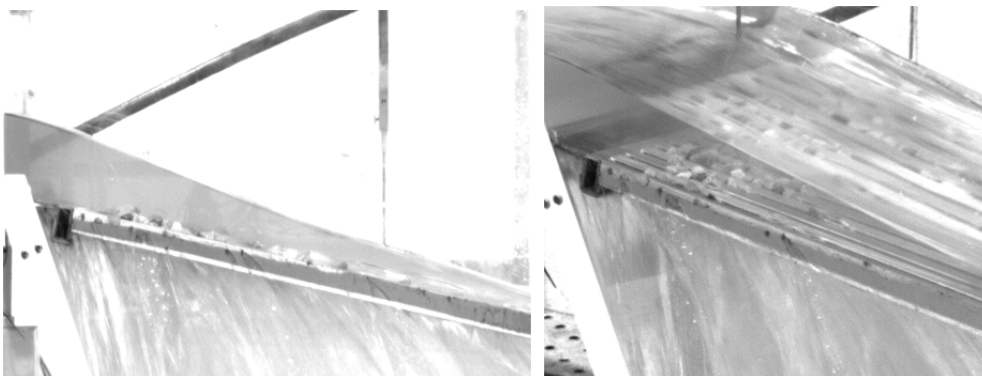
Figura 5.1. Ensayo con gravas sobre la reja del dispositivo físico del Laboratorio de Hidráulica de la Universidad Politécnica de Cartagena
