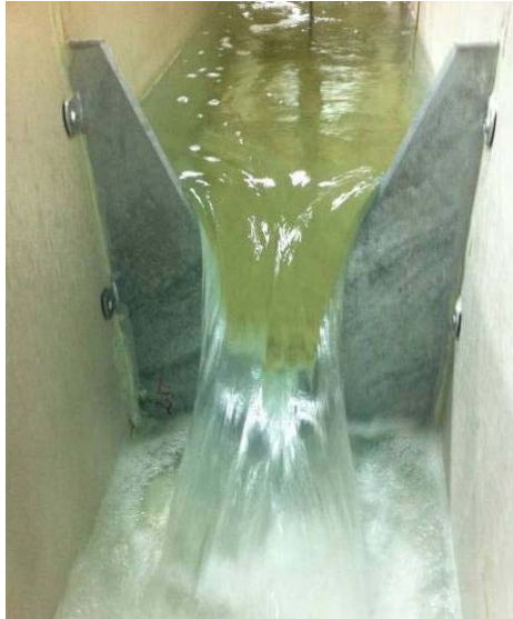
Figura 2.14. Vista del vertedero V-notch 45° instalado.
