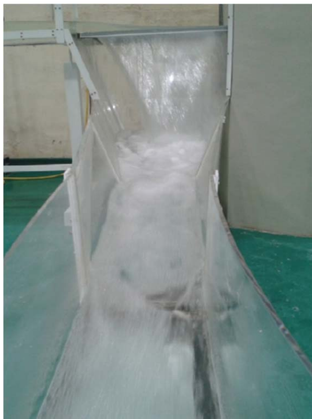
Figura 2.26. Vista de la zona transición del canal de agua captada.
