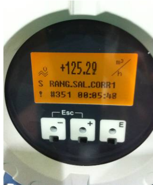
Figura 2.16. Caudalímetro instalado a la entrada del circuito.
