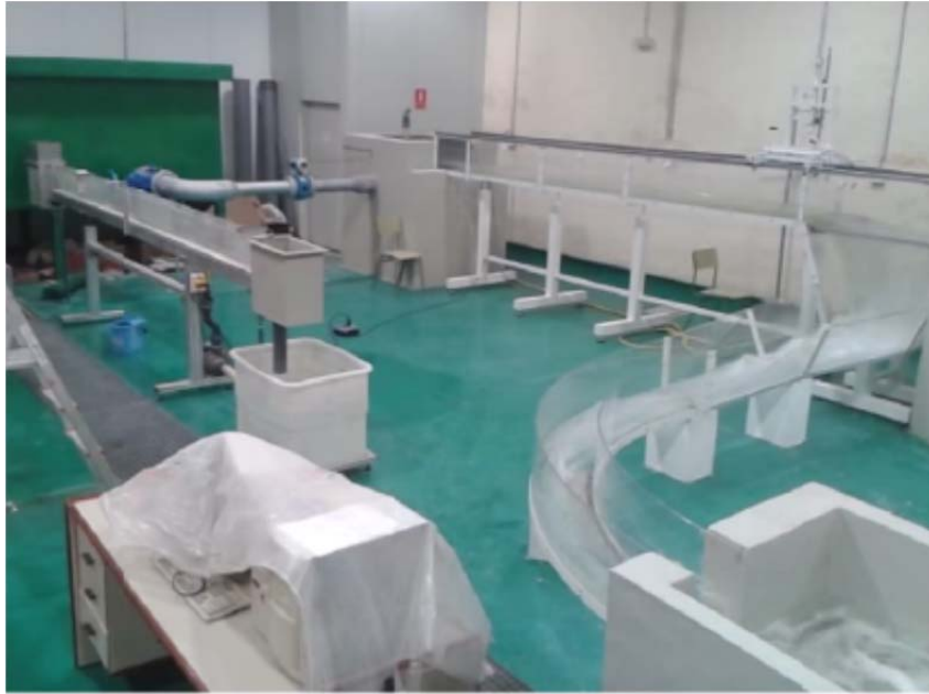
Figura 2.20. Vista de la infraestructura de captación mirando hacia aguas arriba. donde se observa el canal de aproximación la arqueta de toma las conducciones con el caudalímetro electromagnético y el depósito de toma.
