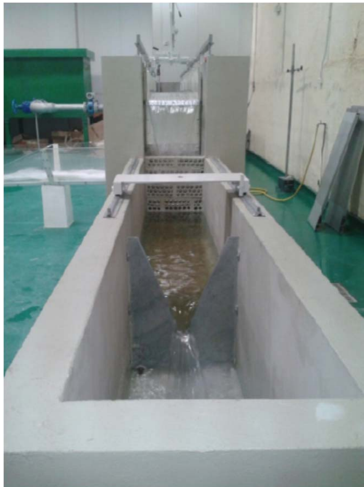
Figura 2.28. Vista del canal de descarga con el vertedero triangular a 45°.
