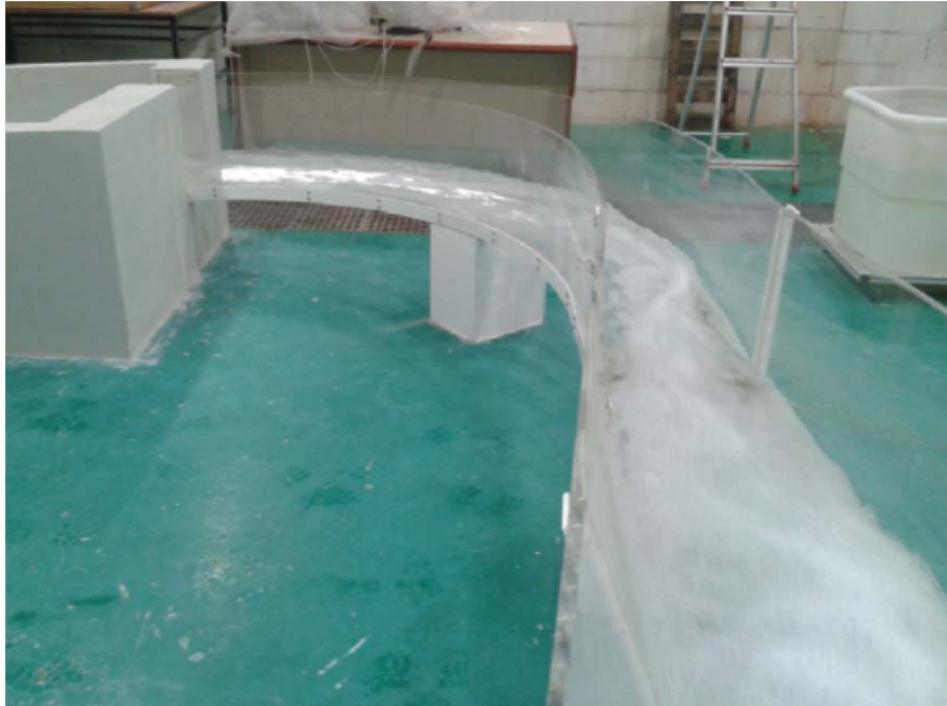
Figura 2.27. Canal de eje circular de caudal captado hacia el desarenador.
