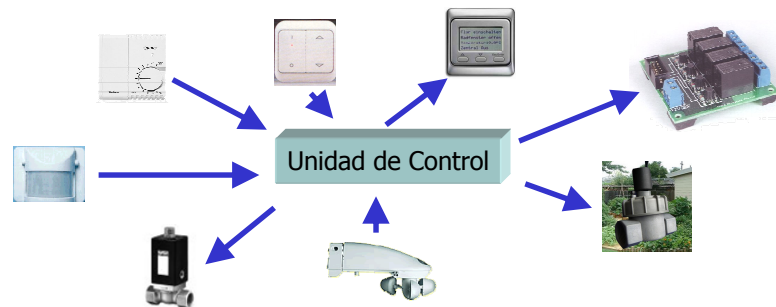
Figura 2-6. Ejemplo de arquitectura centralizada en sistema domótico.
