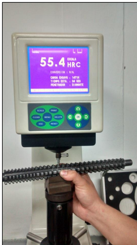
Figura 12. Verificación de la dureza después del tratamiento térmico.
