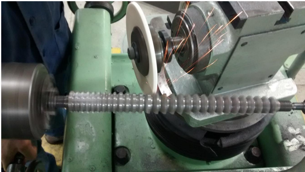
Figura 15. Afilado de la periferia del diente.
