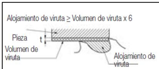
Figura 1. Alojamiento de la viruta por diente de corte.
