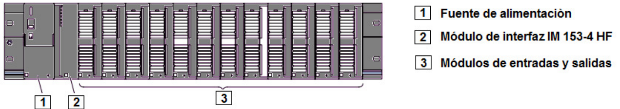
Ilustración 27 Composición de estación descentralizada ET-200
