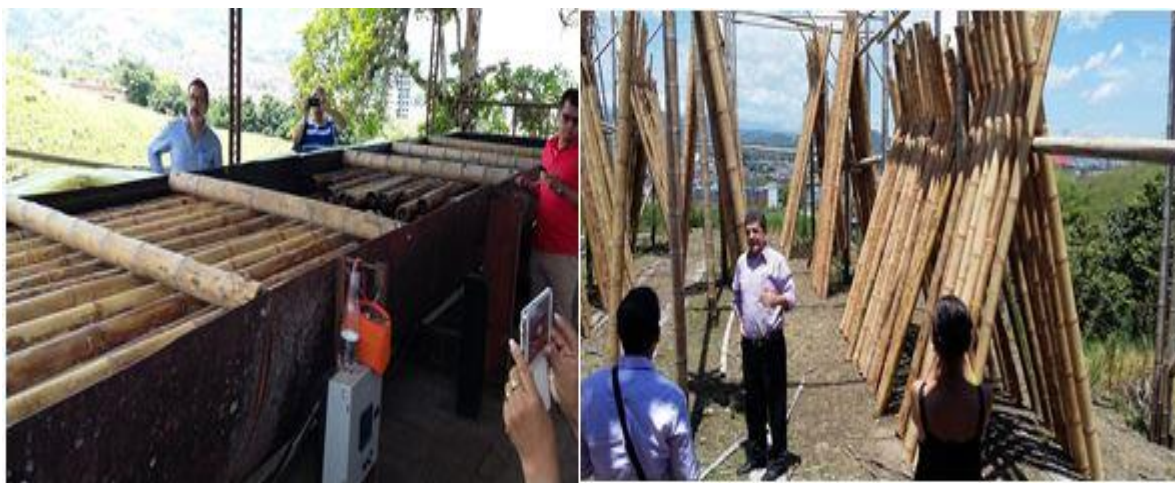
Figura 4: Culmos de guaduas curadas por inmersión y a cielo abierto
