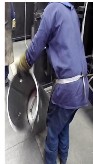
Imagen 6. Puesto 4. Resoldado de la base y el costado del tanque. Descarga del tanque (fuente propia).
