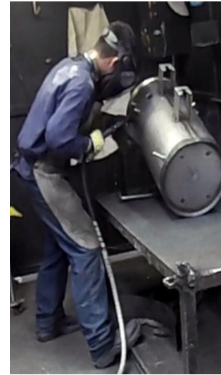
Imagen 12. Puesto 6. Resoldado de piezas externas. Cordón tanque inclinado (Fuente propia).
