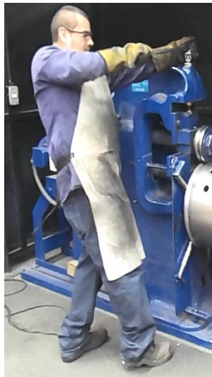
Imagen 7. Puesto 3. Bordeado de la base del tanque. Torsión. (Fuente propia)
