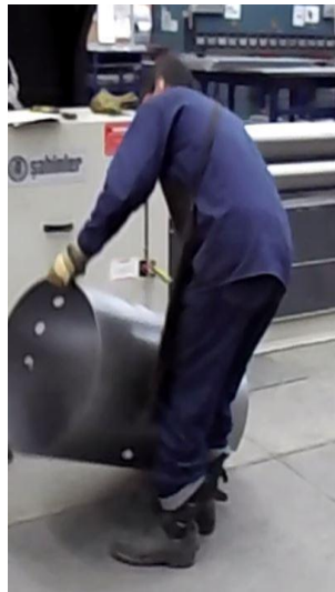
Imagen 19. Puesto 1 Demarcación de Huecos. Levantar el tanque (Fuente propia)
