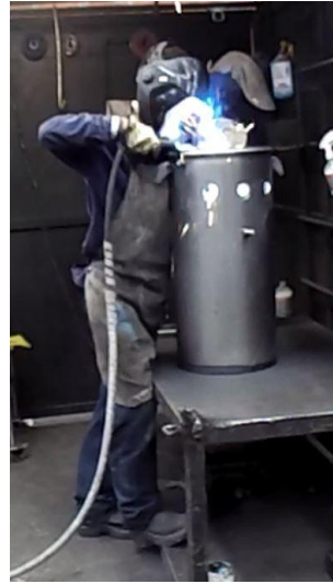
Imagen 11. Puesto 6. Resoldado de piezas externas. Cordón pieza interna del tanque (Fuente propia).
