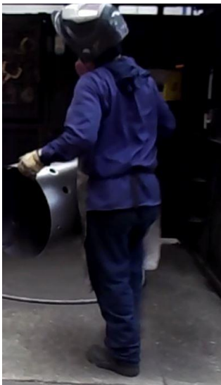
Imagen 3. Puesto 2 Punteado del cilindro, base y pegado de piezas internas.. Levantamiento del cilindro (Fuente propia).
