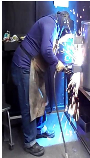
Imagen 8. Puesto 5. Punteado de piezas externas. Punteado de pieza 2 (fuente propia).
