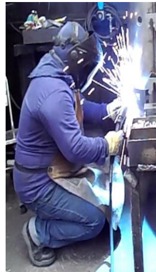
Imagen 9. Puesto 5. Punteado de piezas externas. Posicionamiento y soldadura de pieza 8 (fuente propia).
