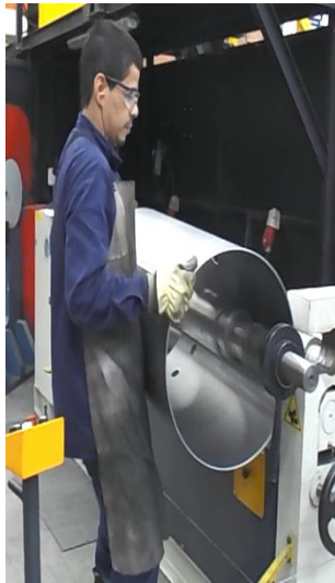
Imagen 1. Puesto 1 Doblado de lámina. Deslizar y retirar lamina ondulada (Fuente propia)
