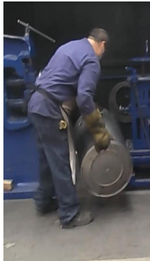
Imagen 6. Puesto 3. Bordeado de la base del tanque. Posicionar tanque. (Fuente propia)
