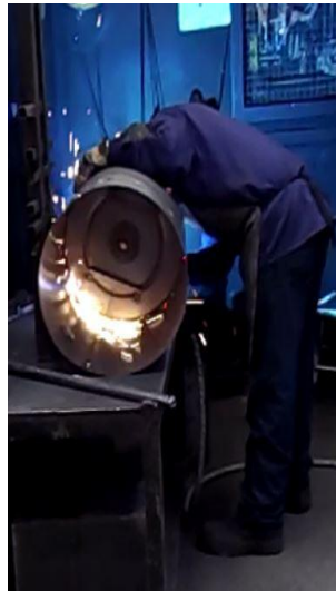
Imagen 23. Puesto 2. Punteado de Cilindro y de tapa inferior. (Fuente propia)
