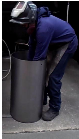
Imagen 25. Puesto 2. Puenteado de Cilindro y de tapa inferior, pega de accesorios internos. (Fuente propia)
