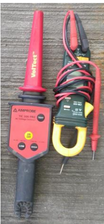
Figura 66. Detector de tensión y Pinza voltiamperimétrica
