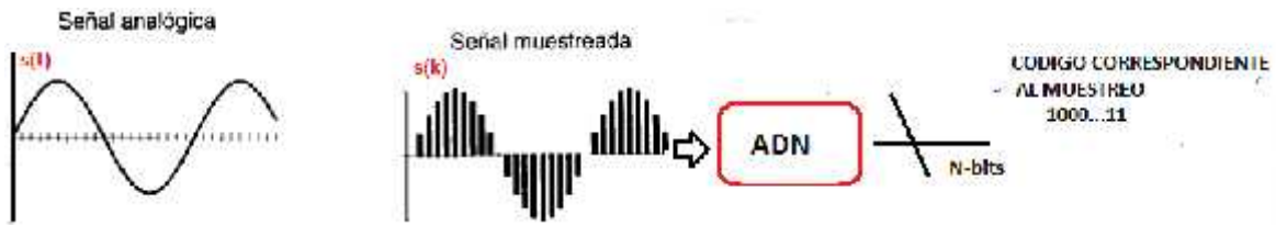
Figura. 3.15: Proceso de Conversión Análogo- Digital [AUTOR]
