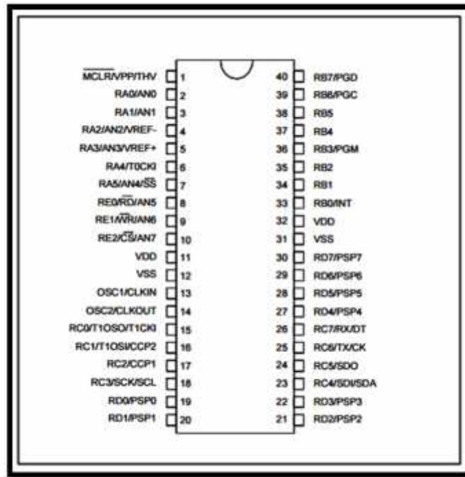
Figura 3.4: Distribución de pines PIC16F877 [14]
