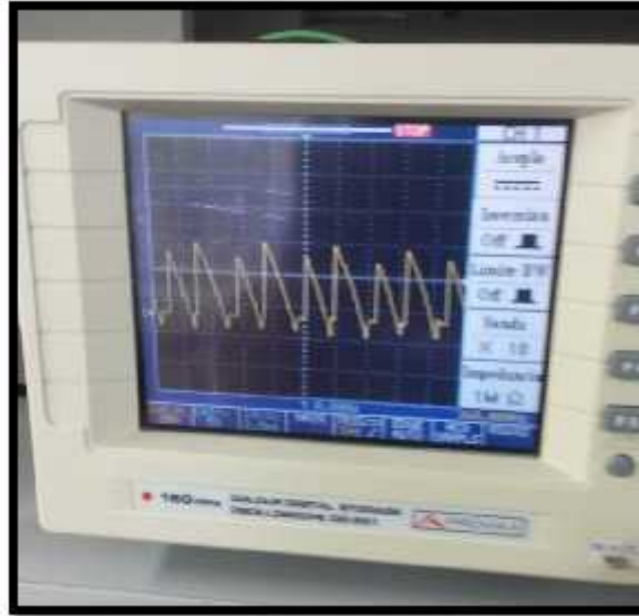
Figura 4.29: Señal rectificada para un ángulo de disparo =90^\circ con Carga RL [AUTOR]
