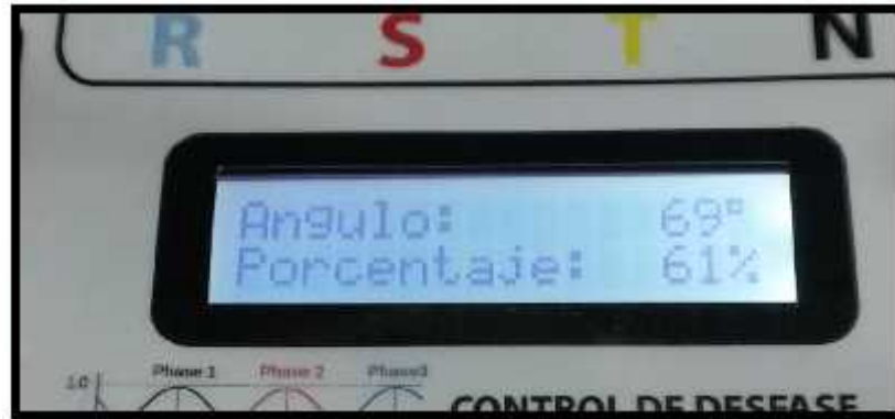
Figura 3.20: Pruebas de funcionamiento Display LCD [AUTOR]
