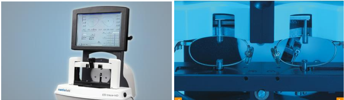
Figura 13: Trazador de lentes y lentes.
