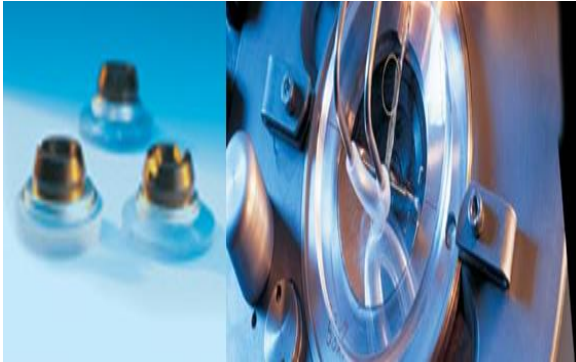
Figura 7: Bloqueo de la lente.
