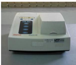
**Espectrofotómetro de UV-VISIBLE:** Utilizado para hacer el barrido espectral.
