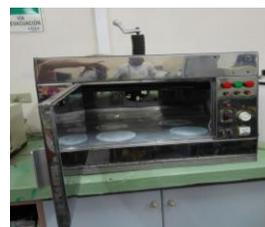
**Cristalizador:** Utilizado para la degradación de los contaminantes en el reactor helio fotocatalítico.
