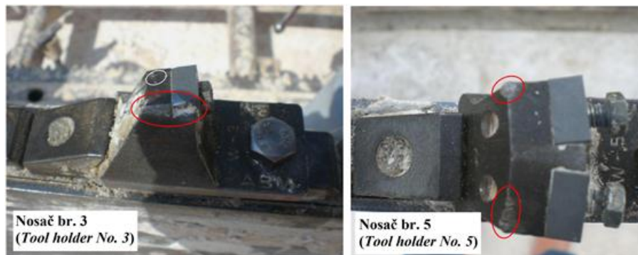
Slika 7. Oštećenja nosača pri radu sjekačice
