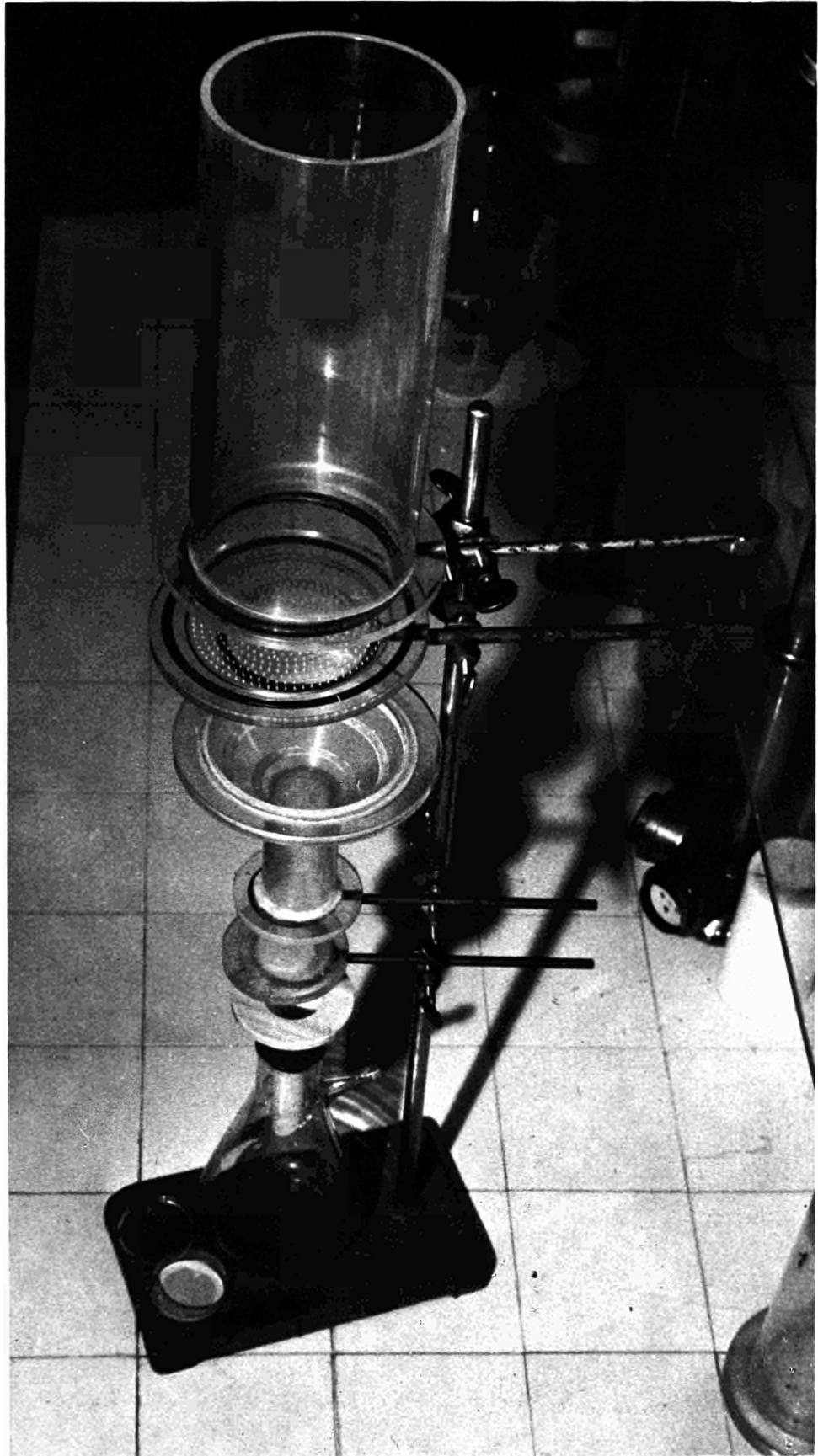
Figura 5 Doppio imbuto di Buckner smontabile per la filtrazione di grandi volumi di acque su ammonio fosfomolibdato (AMP).
