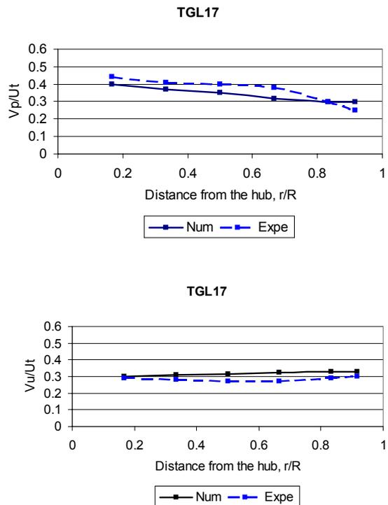
Figura 6: Velocidad absoluta  $v_p$  y componente tangencial  $v_u$  en el plano TGL17.
