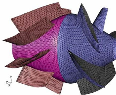
Figura 1. Detalle del mallado de la bomba
