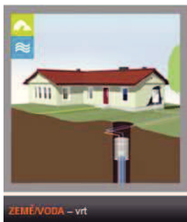
obrázek č. 2 – tepelné čerpadlo země/voda – vrt
