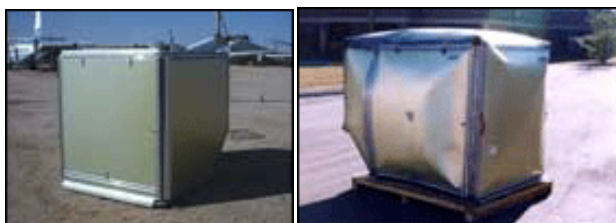
Obrázek 16: Tvrzený bezpečnostní kontejner (před a po výbuchu) [40]
