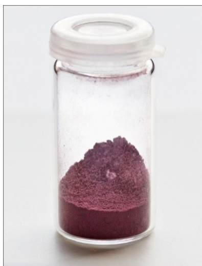
Obr. 10: Vysušený biosyntetizovaný kompozit obsahující nanočástice zlata
