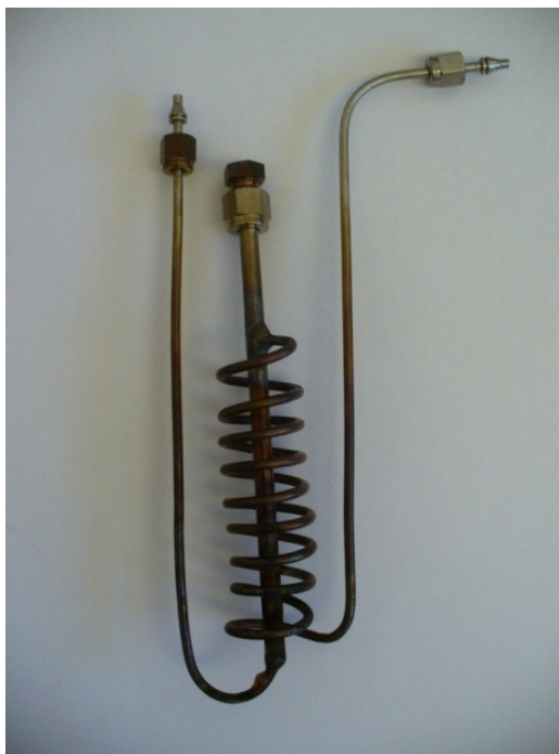
Obr. 7: Trubkový reaktor se spirálou k předehřívání vstupujícího plynu
