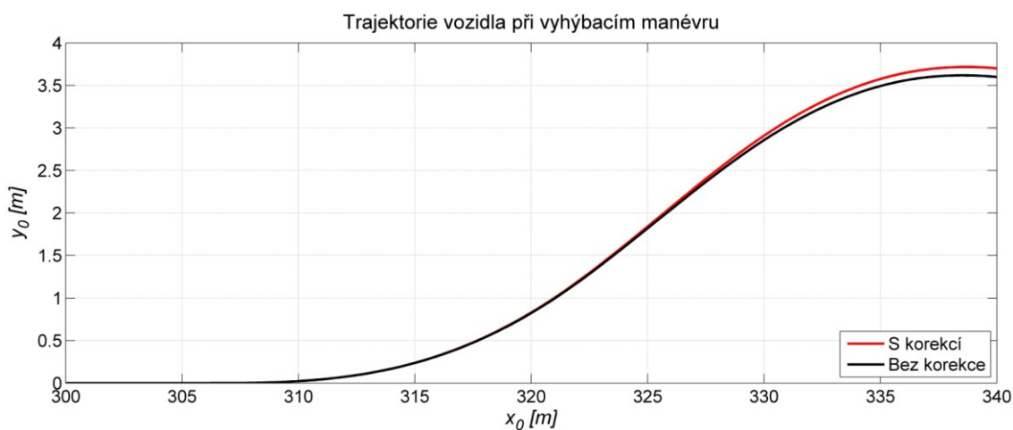
Obrázek 5.6 Trajektorie automobilu při vyhýbacím manévru
