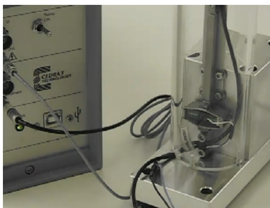
Obr. 2.4 – Nosník s aktivním tlumením – detail piezoaktuátoru [www.youtube.com, 2011]
