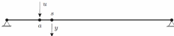
Obr. 2.2 – Systém s aktuátorem a snímačem umístěným na stejném stupni volnosti [Preumont, 2008]
