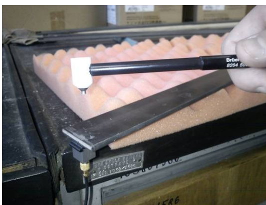
Obr. 2.19 – Provádění modální analýzy
