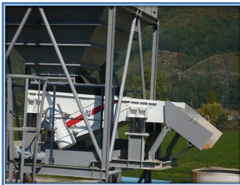
Obr. 2: Vibrační doprava mikrovřhem [7]
