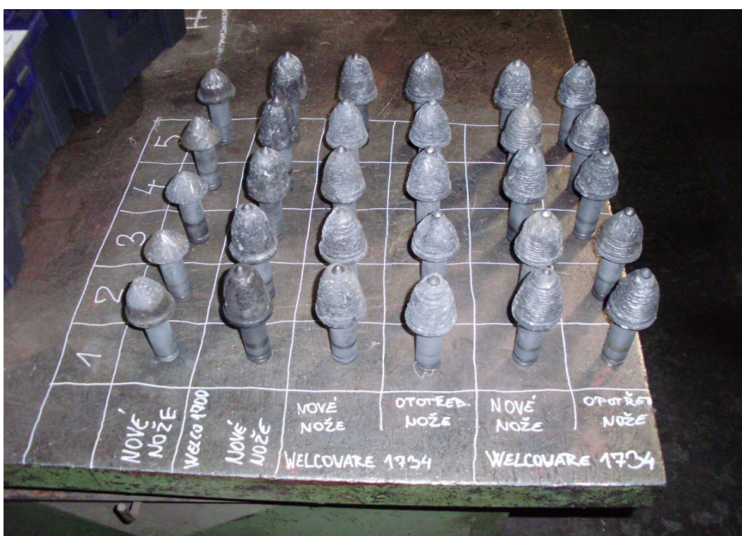
Příloha č. 3.3 Sestavení zkoušených nožů do porovnávacího pole
