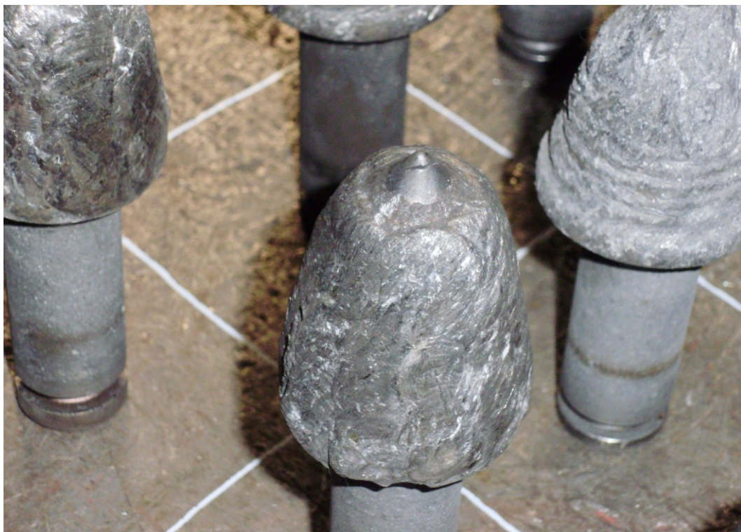
Příloha č. 3.4 Prasklina špičky na pozici č. 4 preventivně navařeného nože PM WELCO 1700
