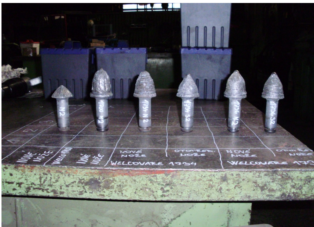
Příloha č. 3.7 Nejvíce opotřebená řada zkoušených nožů se znatelným opotřebením funkční délky nože
