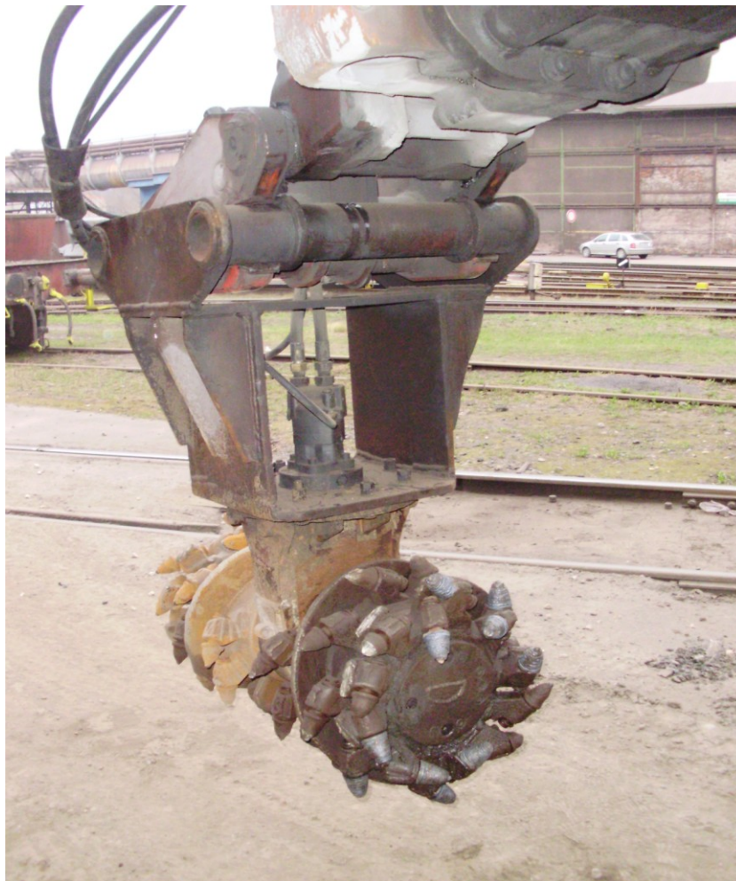
Obr. 1 Skalní fréza BOART LONGYEAR BF300 D5
