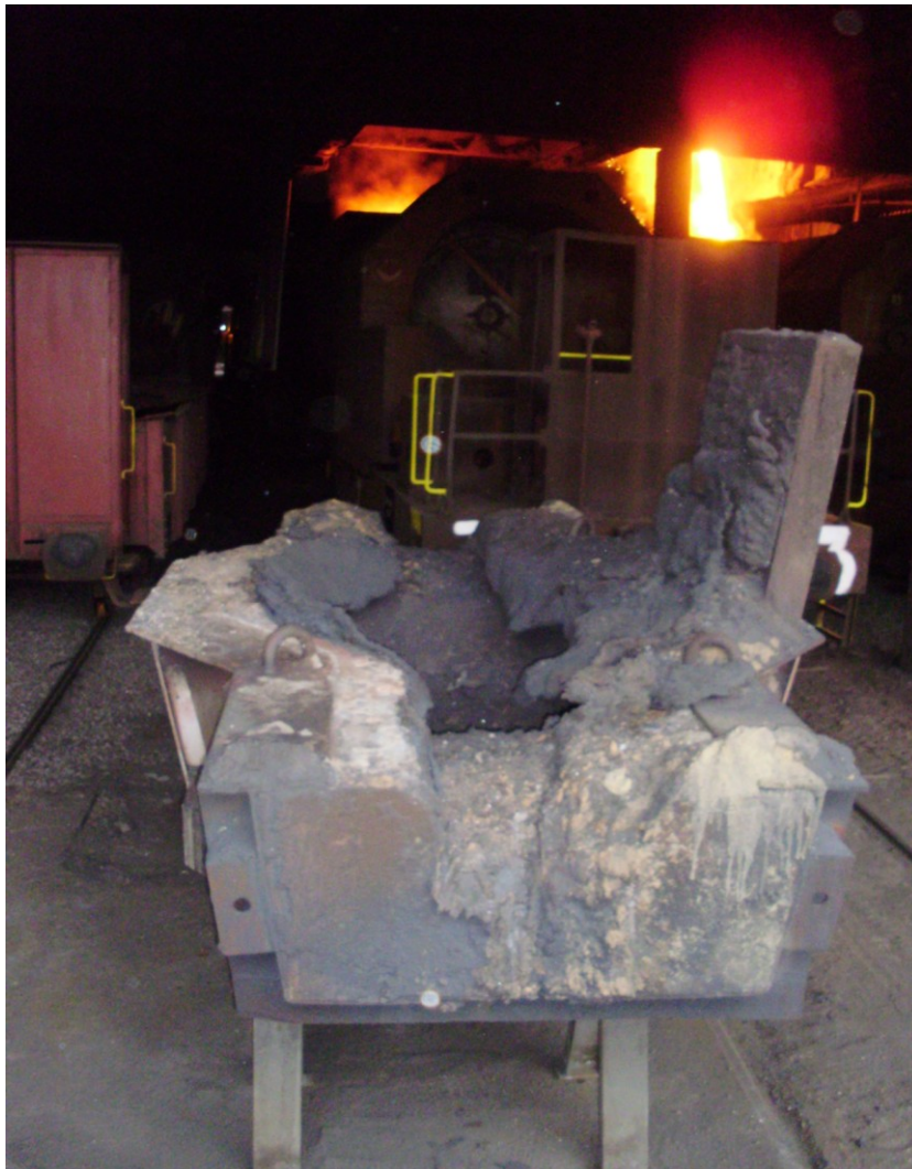
Obr. 12 Překlápěcí žlab vysoké pece před renovací frézováním
