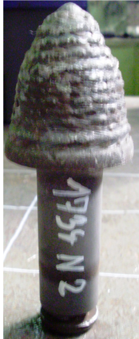
Příloha č. 3.9 Porovnání dvou opotřebovaných nových nožů, preventivně navařených materiály WELCOWARE 1736 a WELCOWARE 1734
