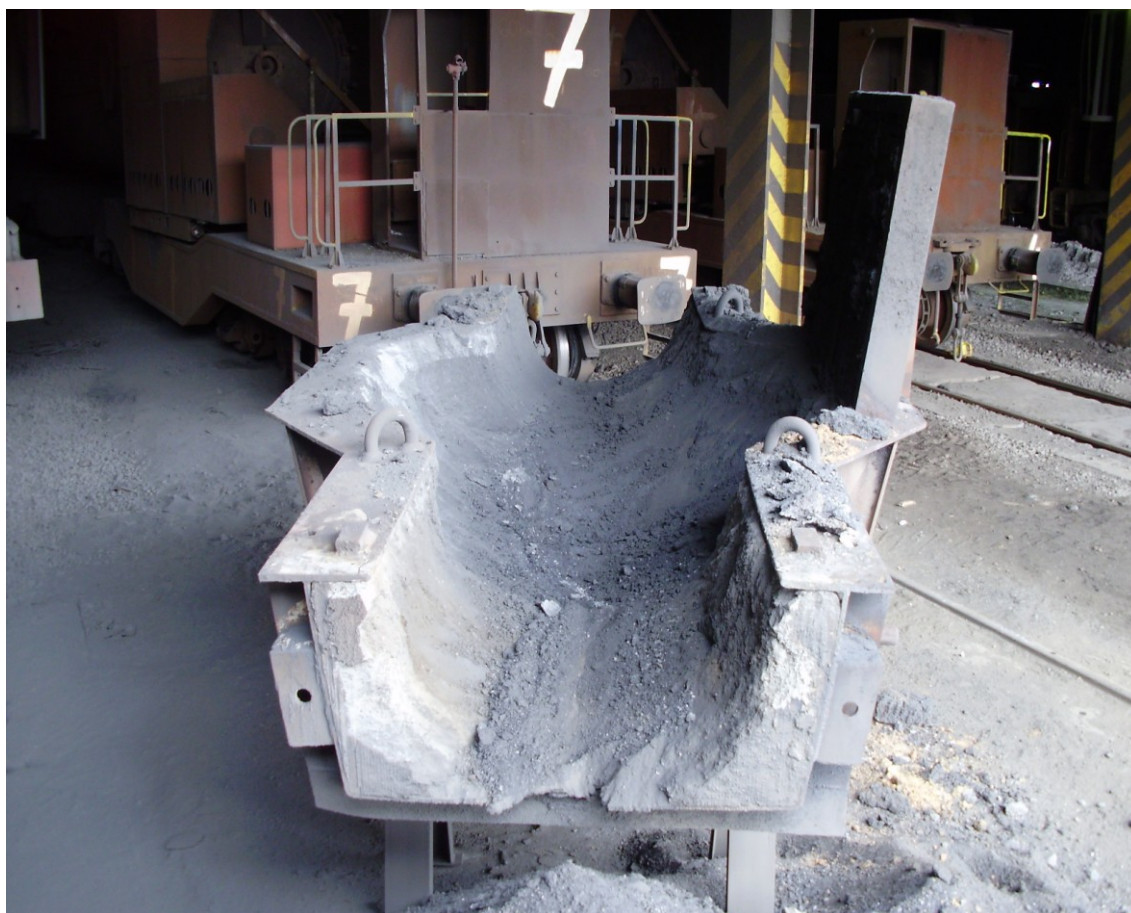
Obr. 14 Překlápěcí žlab po frézování
