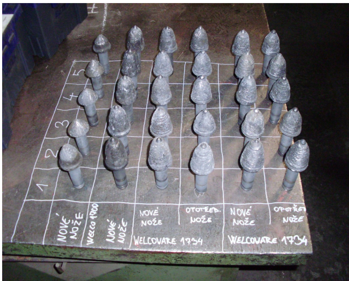
Obr. 15: Srovnávací pole opotřebovaných vzorků
