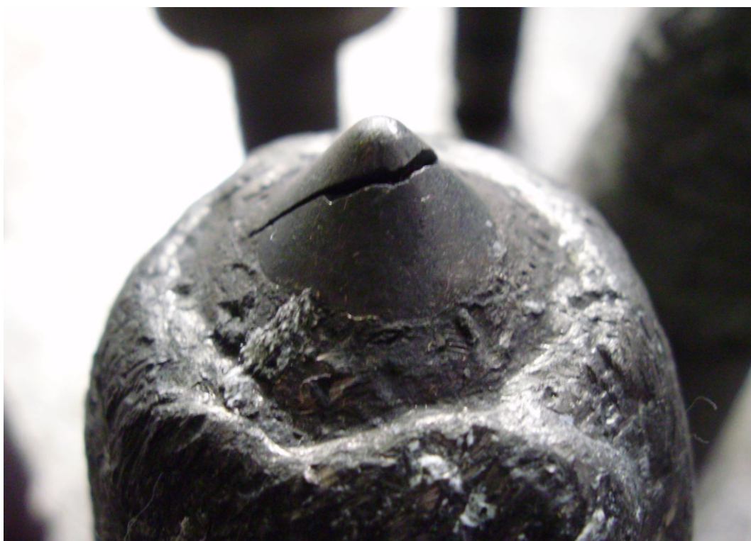
Příloha č. 3.5 Detail praskliny karbidové špičky
