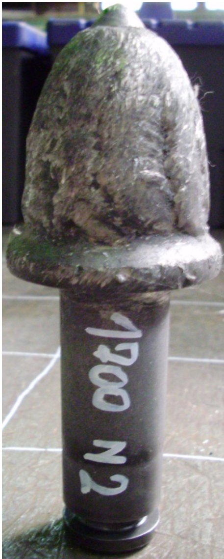
Příloha č. 3.8 Porovnání dvou opotřebovaných nových nožů, první je preventivně navařený materiálem WELCO 1700 a druhý je bez jakékoliv ochrany
