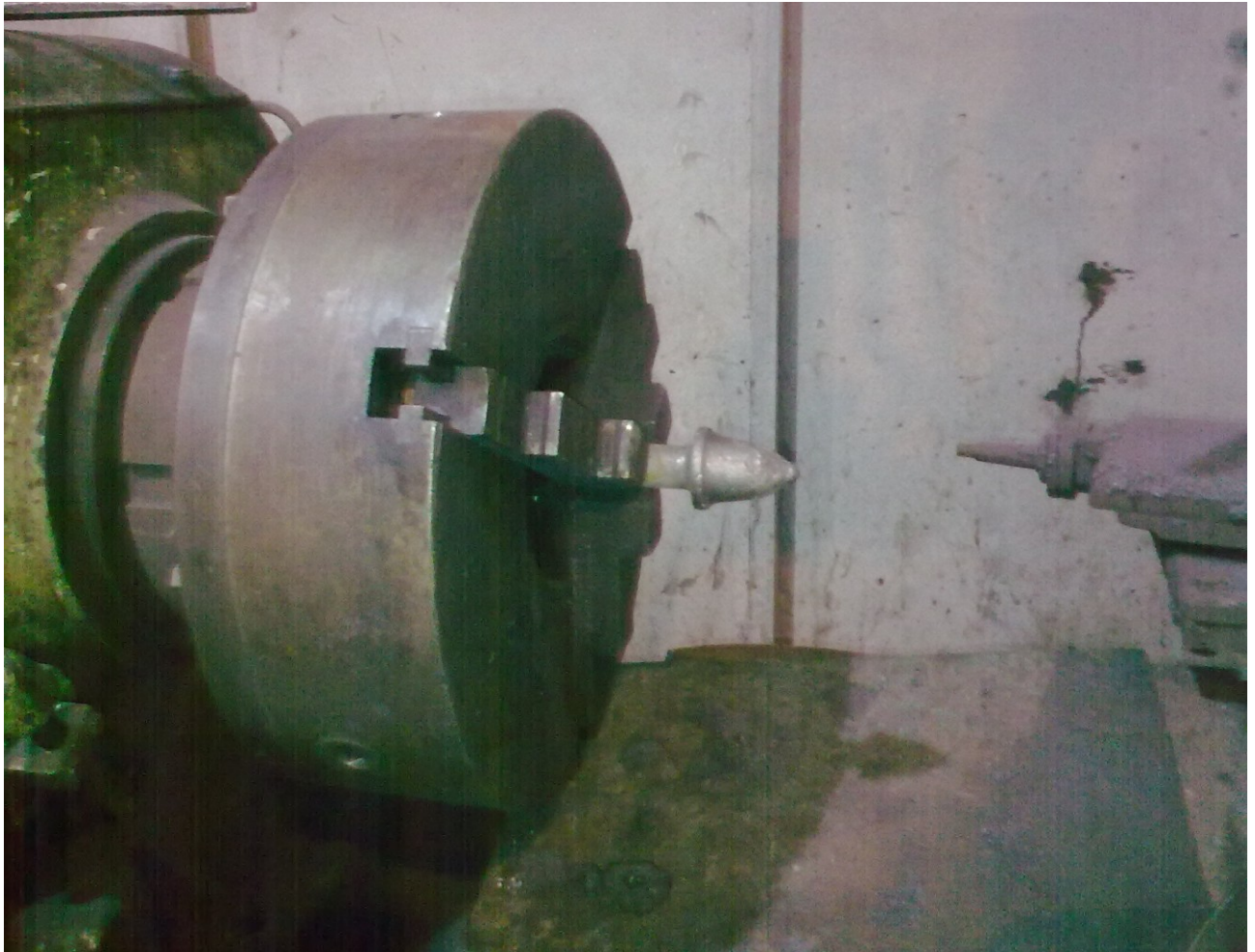
Příloha č. 3.1 Upevněný nůž v polohovadle pro MAG navařování plněným drátem
