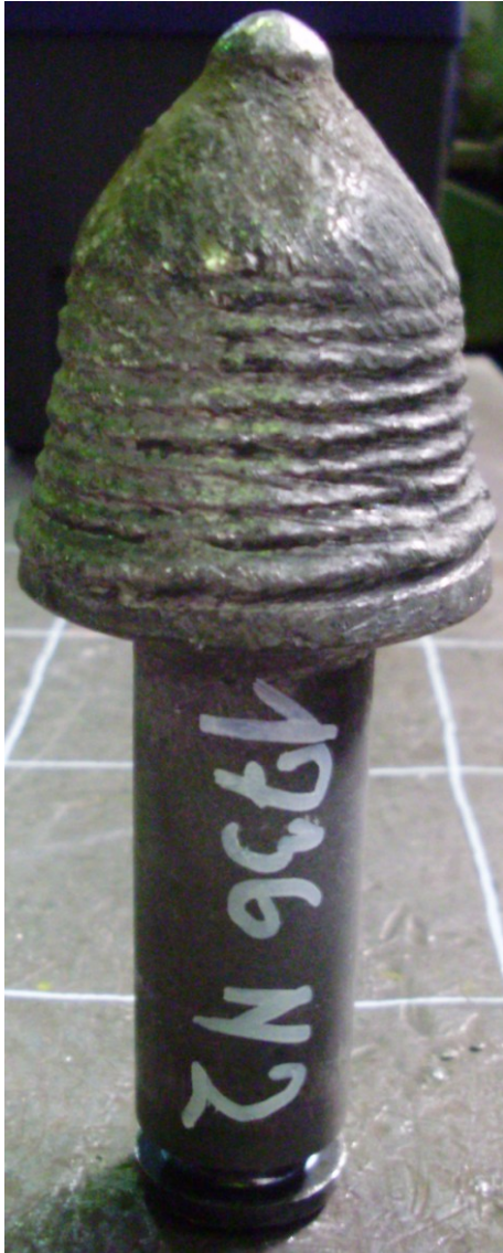
Příloha č. 3.9 Porovnání dvou opotřebovaných nových nožů, preventivně navařených materiály WELCOWARE 1736 a WELCOWARE 1734
