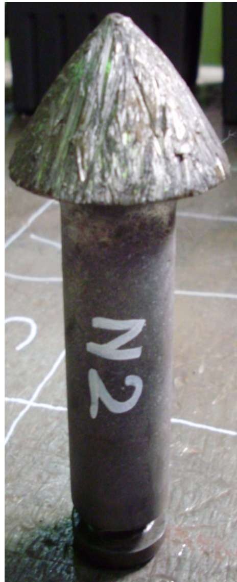
Příloha č. 3.8 Porovnání dvou opotřebovaných nových nožů, první je preventivně navařený materiálem WELCO 1700 a druhý je bez jakékoliv ochrany
