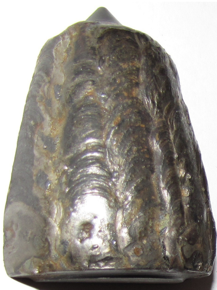
Obr. 6 Povrch nože navařeného obalenou elektrodou WELCO 1700
