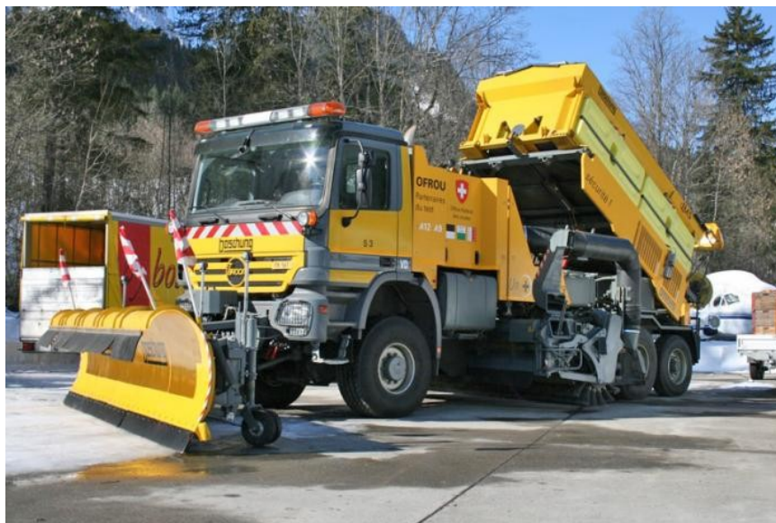
Obr. 1.4 Zařízení na mechanické odstraňování sněhu BoschungAG
