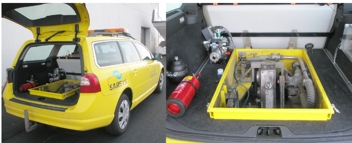
Obr. 3.2 Vozidlo se zařízením Sarsys Volvo Friction Tester
