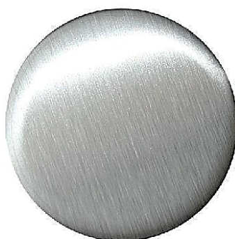
obr. 5.1 – vzhled oceli 1.4301, kartáčováno [12]
