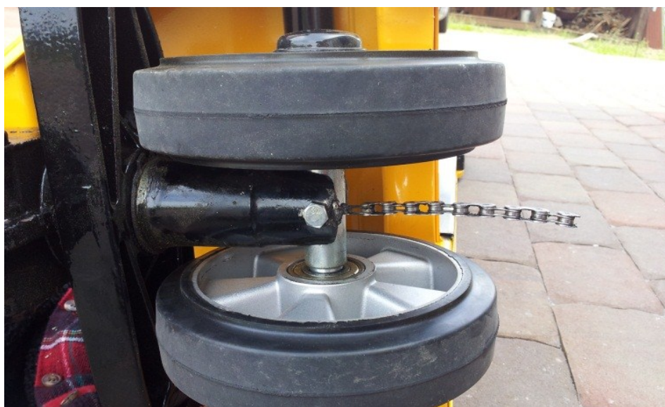
obr. 5.7 – přivařený uzemňovací řetěz
