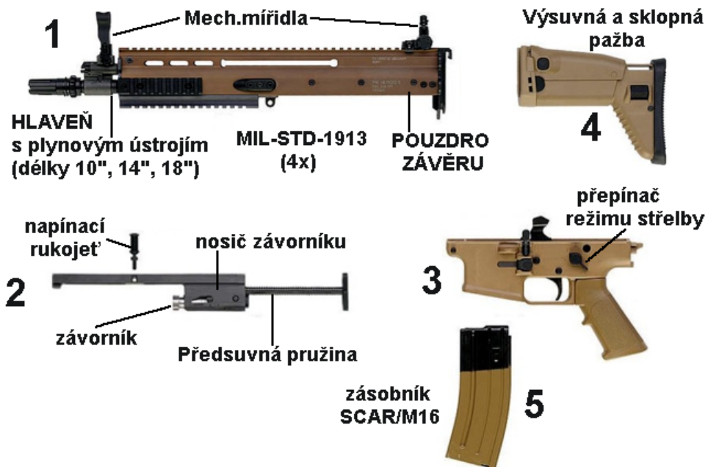
Obr. 6.15 SCAR-L rozložená na moduly [23]
