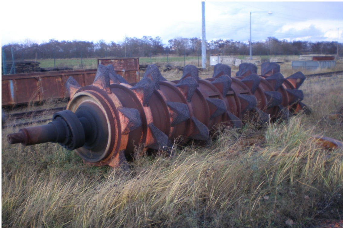
Obrázek 21 – Rotor kruhadla s lichoběžníkovými zuby
