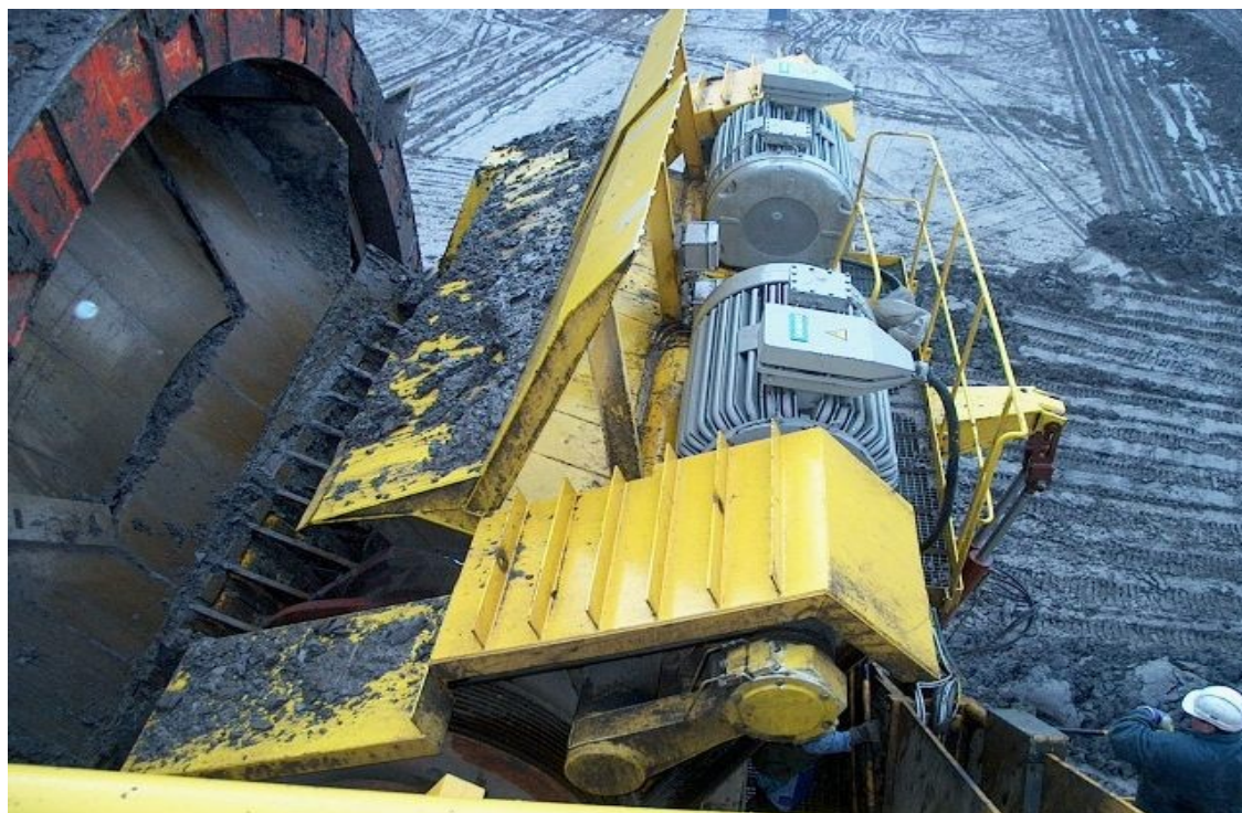
Obrázek 22 – Pohled na zakrytování rotoru, zakrytování hnací a hnané řemenice s řemeny a na hnací elektromotory
