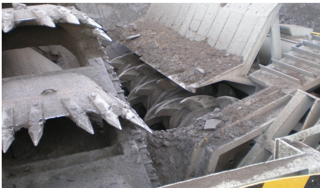
Obrázek 24 – Kruhadlo na SchRs1320 s rotorem osazeným prstenci s hroty profilu “žraločích ploutví”
