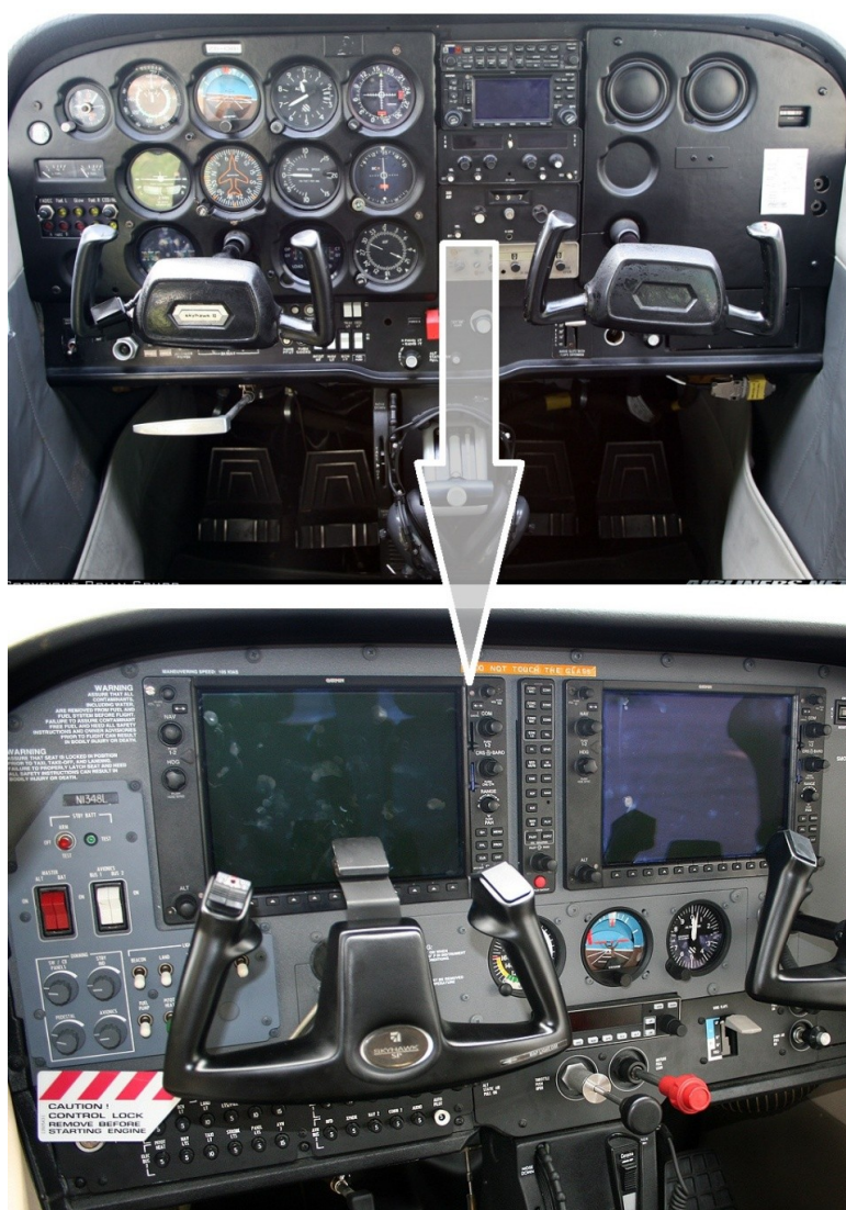
Obr. 3 – Srovnání palubní přístrojové desky letounu Cessna C172S [14]
