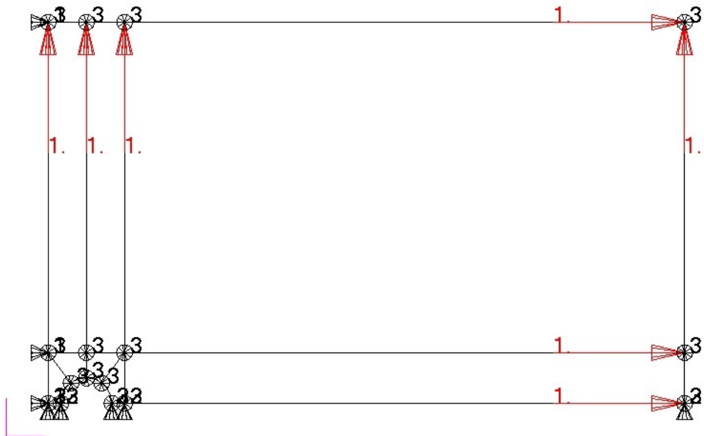
Obr. 20 Schéma čtvrtiny modelu desky s dvěma otvory pro \lambda = 1,5 včetně okrajových podmínek pro dvojosý tah
