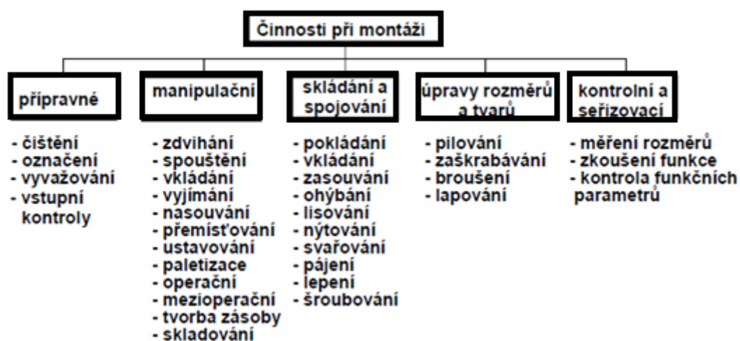
Obr. 2.1 - Rozdělení montážních činností [3]
