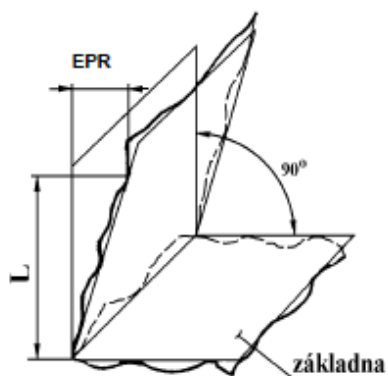
Obr. 3.4 Odchylka kolmosti rovin [4]
