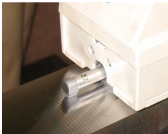
Obr.č.34. Detail měření drsnoměrem Mitutoyo Surftest – 211
