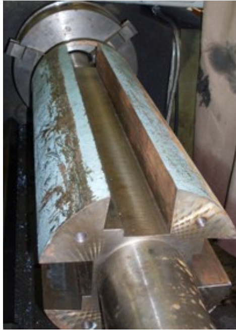
Obr.č.22. Fotografie upnutého přípravku bez lišt
