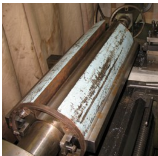
Obr.č.23. Fotografie přípravku s třemi neupravenými lištami
