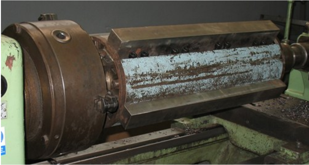
Obr.č.24. Fotografie přípravku připraveného k úpravě lišt
