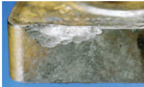
Obr. 7. 7. Mechanické opotřebení – vylamování bříty, celkový lom [2].
