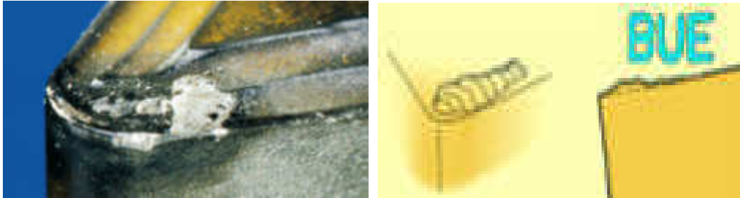
Obr. 7. 3. Adhezní opotřebení – tvorba nárůstku [2].
