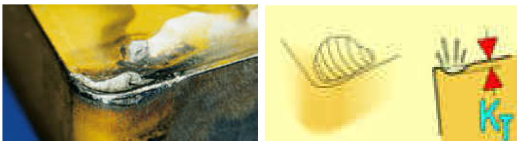
Obr. 7. 2. Chemické opotřebení ve tvaru žlábků [2].
