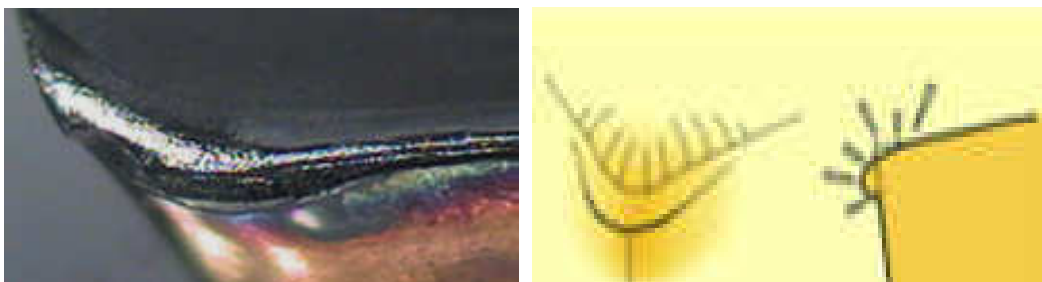
Obr. 7. 5. Tepelné opotřebení – plastická deformace [2].
