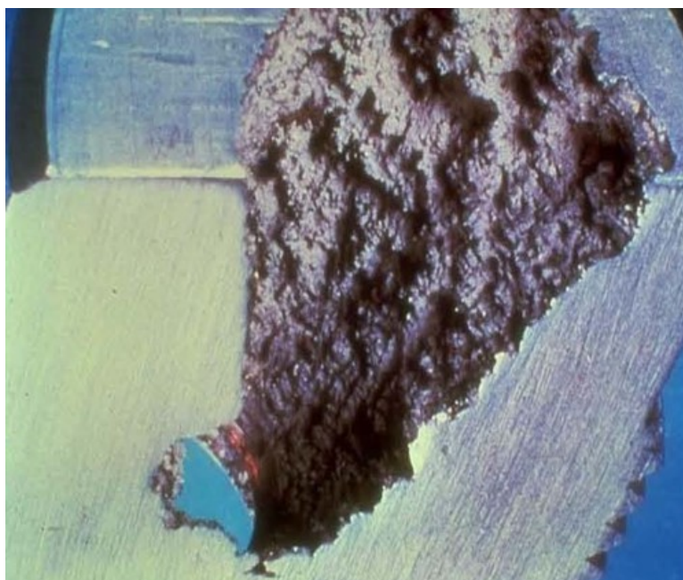
Obrázek 6. Typický vzhled kavitačního působení na povrch [21]
