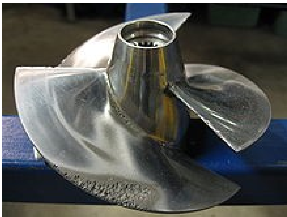
Obrázek 1. Lodní šroub poškozený kavitací [25]
