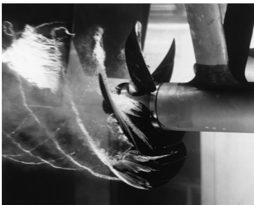
Obrázek 2. Příklad vláknové kavitace uvnitř proudu kapaliny, přemísťující se oblast [25]
