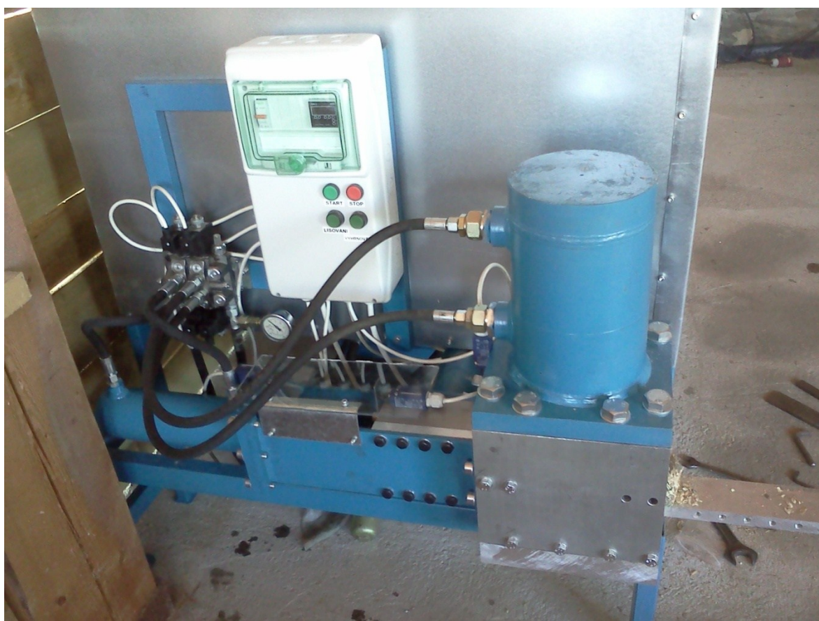
Obr. 17 – Pohled na lisovací komoru a ovládání lisu
