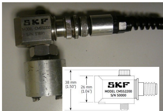
Obr. 42 Použitý snímač SKF CMSS2200
