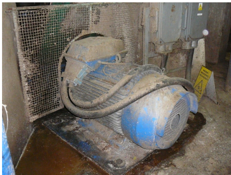
Obr. 76 Pohon rozvlákňovače, motor ABB M2BA 315MA4B3
