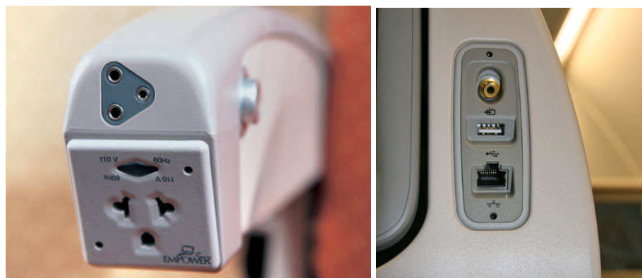
Obr. 42 Napájecí zásuvka, ethernet a USB, AV porty
