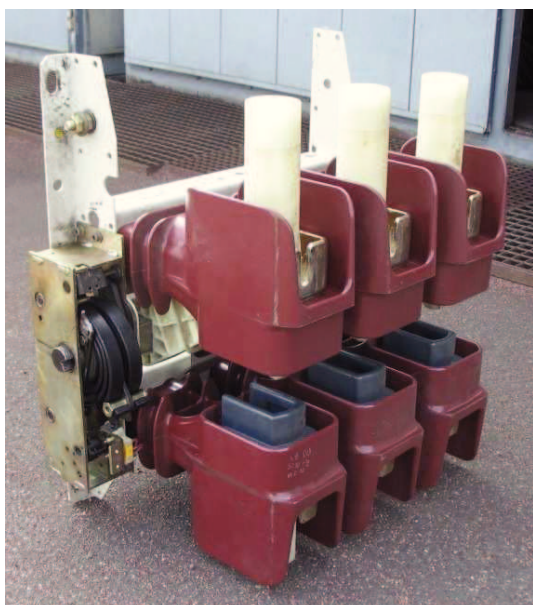
Obrázek 15: Vakuový stykač pro připojení 6 kV motorů
