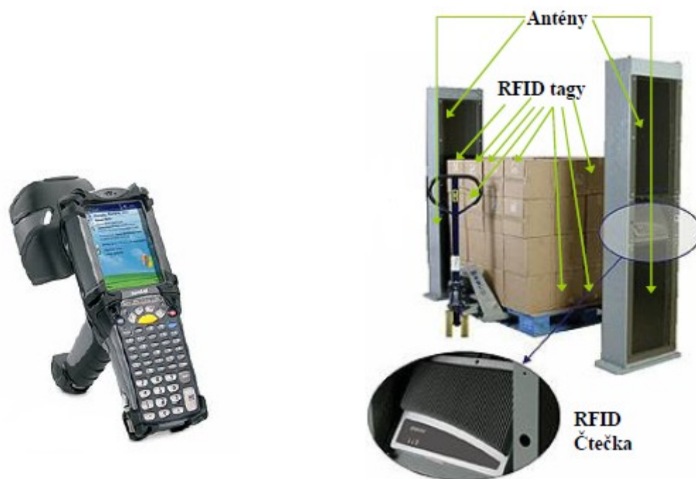
Obr.3 Příklad mobilní čtečky (zleva) a stacionární čtečky – RFID brány [19]
