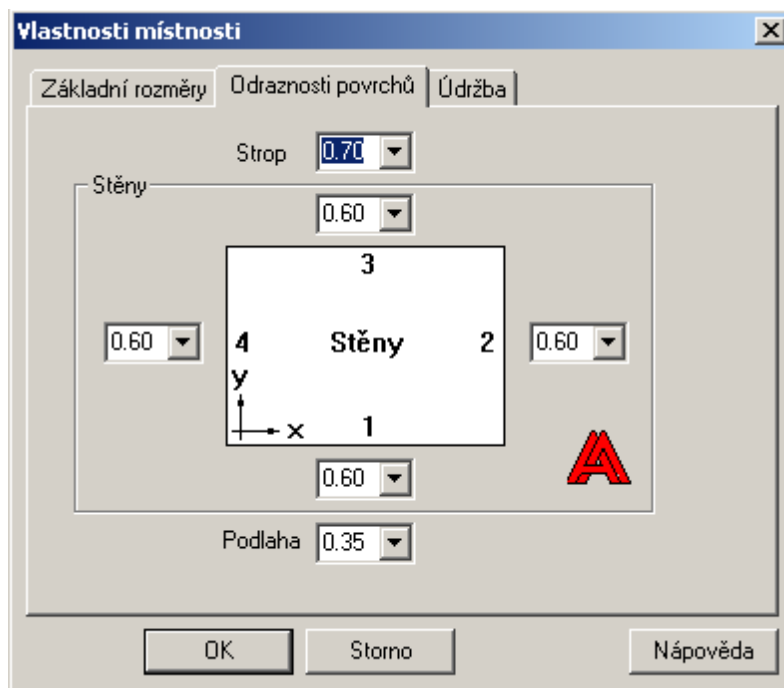
Obr. 2: Nastavení odraznosti povrchů stěn a podlahy
