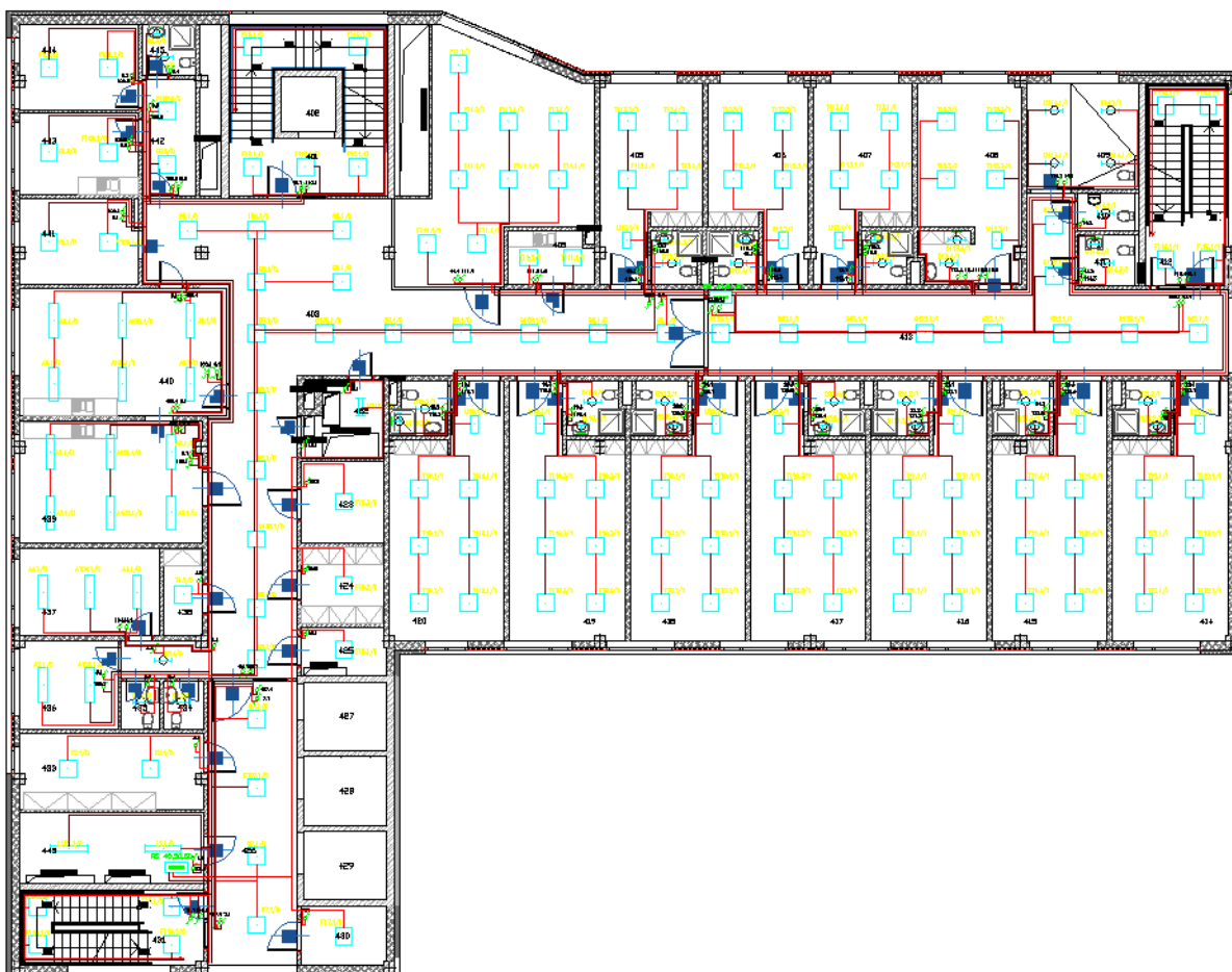
Obr. 15: Navržené výsledné rozvržení světel a jejich elektroinstalace
