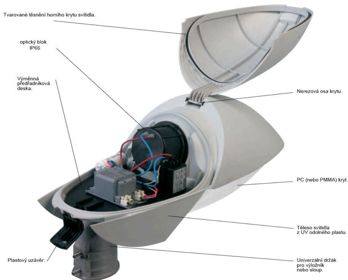
Obrázek 5 příklad svítidla Schröder Atos pro vysokotlakou sodíkovou výbojku [22]
