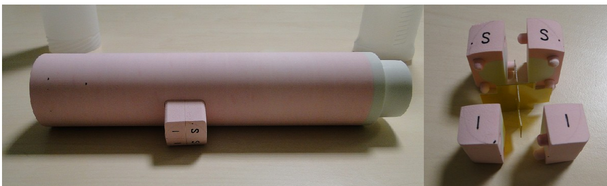
Obr. 5.6.4- Vodící tyč pro filmovou dozimetrii (detail na vkládání filmů).
