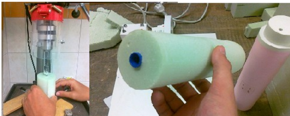
Obrázek 4- Frézování otvoru pro ionizační komoru.
