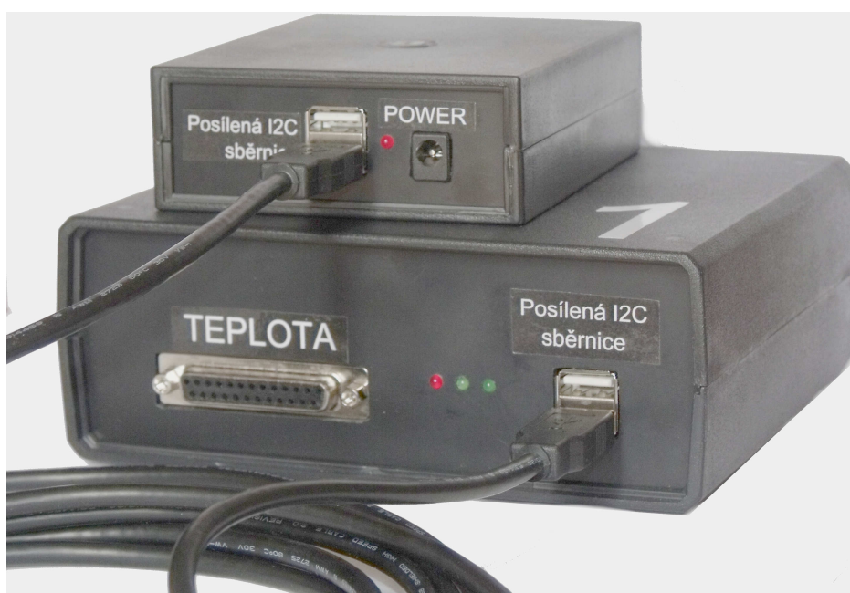
Obr. 22 Komunikační a měřicí deska propojené pomocí I2C sběrnice
