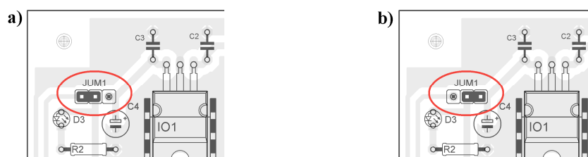
Obr. 26 Zapojení zkratovací propojky JUM1 a) napájení z USB, b) napájení ze síťového adaptéru
