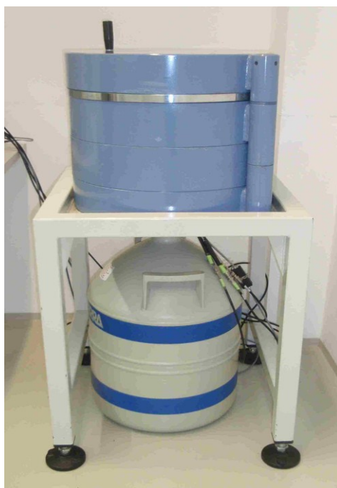
Obrázek č. 3.16 – Germániový polovodičový detektor chlazený kapalným dusíkem
