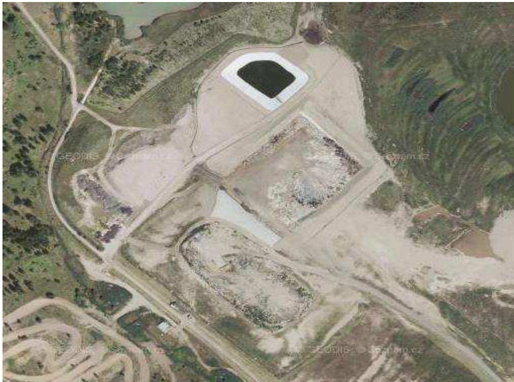
Obrázek č. 8: Situační mapa skládky Vysoká Pec. Kazeta C5-A ve středu obrázku. Nahoře jímka průsakových vod[24]
