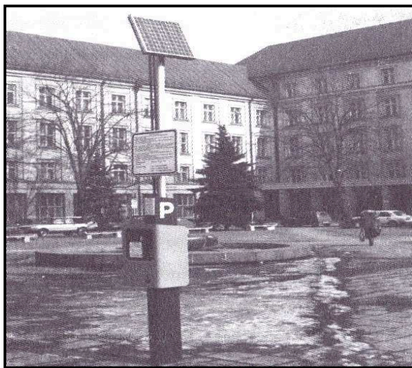
Obr. 2.9 – Parkovací automat napájený z fotovoltaických článků. Zdroj: Cenek, Obnovitelné zdroje energie, 2001
