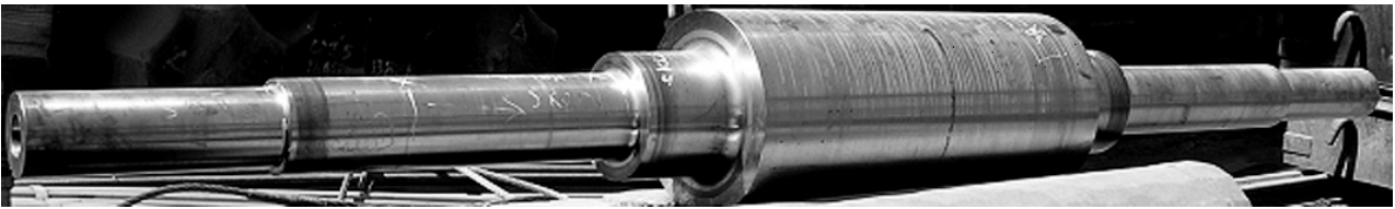
Figure 10: Defective generator rotor shaft – forging No. 447 660 Slika 10: Defektna gred rotorja generatorja – odkovek št. 447 660
