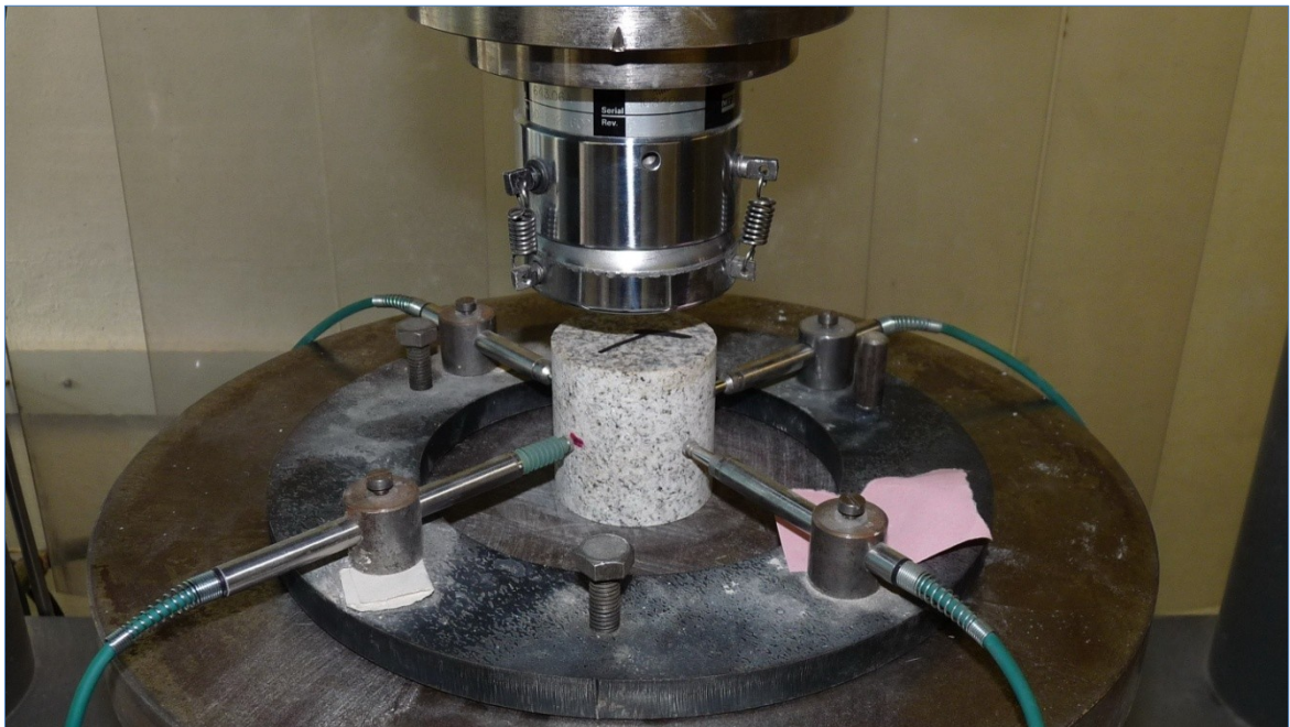
Obrázek 11: Příprava tlakové zkoušky na testovacím zařízení MTS 816 Rock test systém.
