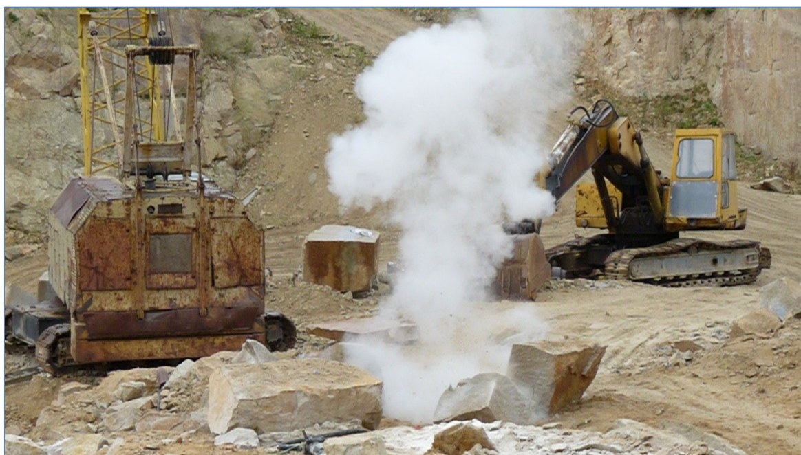
Obrázek 23: Rozpojení bloku č.15 Perunitem 28E - nedělená nálož se 100% nadhodnocením.
