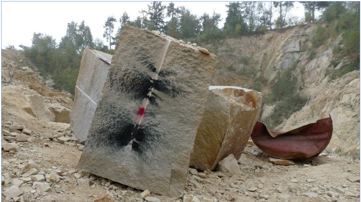
Obrázek 25: Dělenou náloží Vesuvitu TN rozpojený blok č. 2 s označením místa odběru vzorků.
