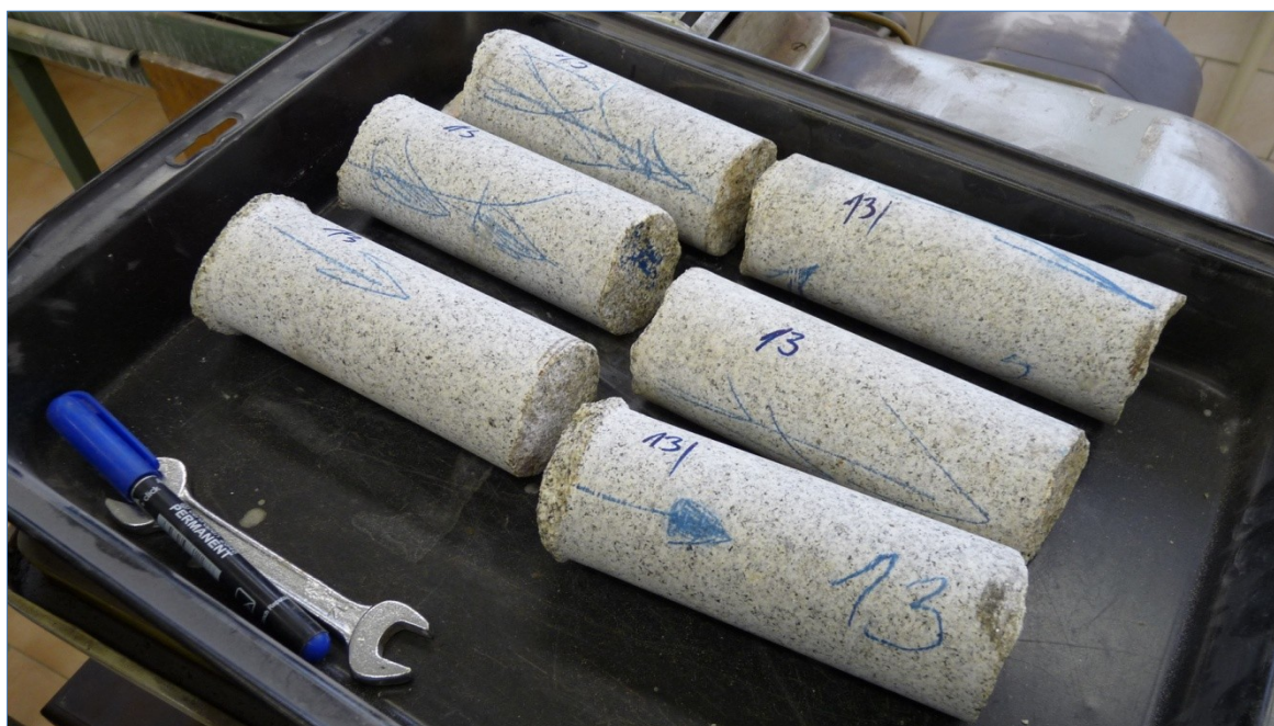
Obrázek 27: Vrtná jádra určená k přípravě zkušebních tělísek.
