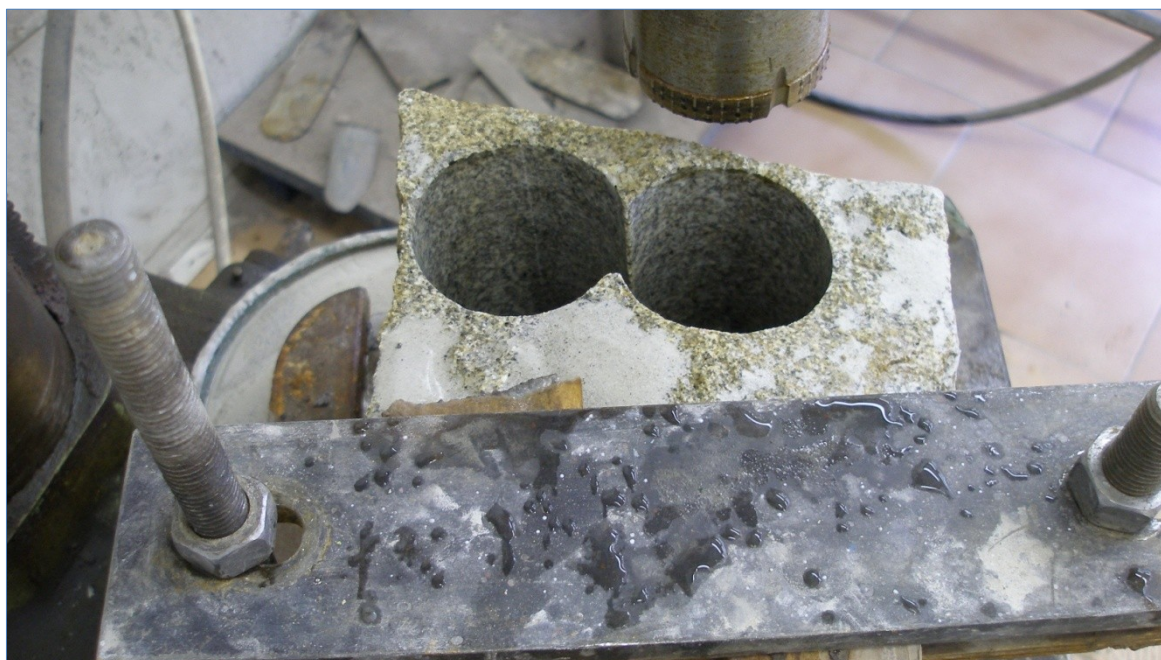
Obrázek 26: Odvrtávání vzorků ve ZLVCH VŠB - TU Ostrava.
