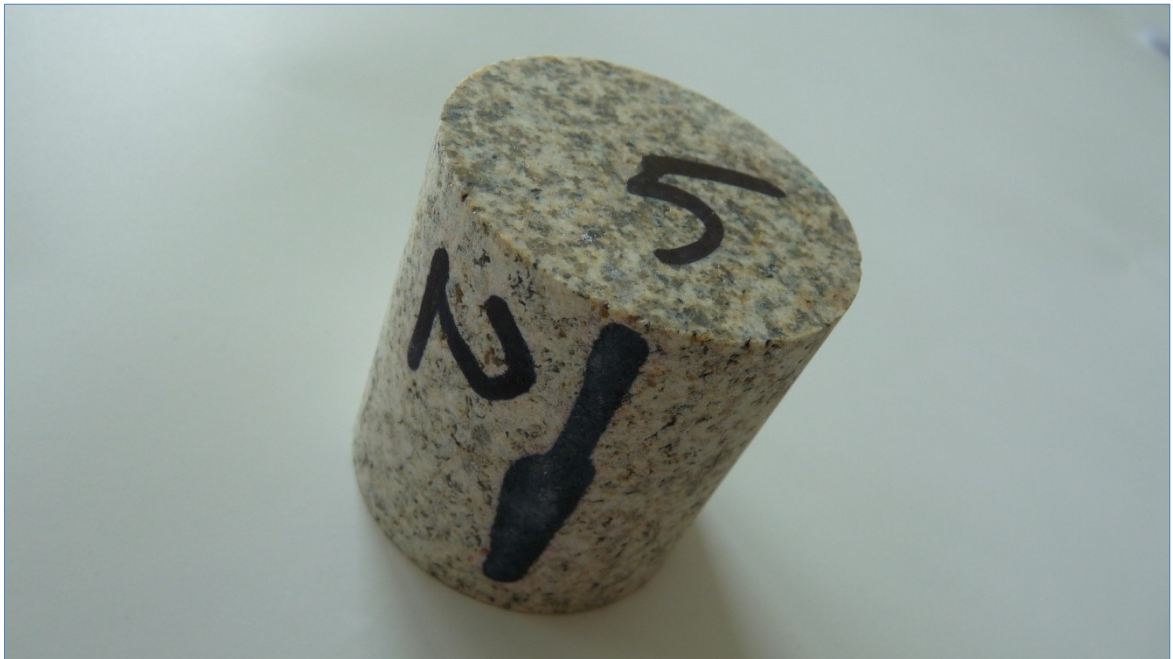
Obrázek 29: Zkušební tělísko 2_5 zhotovené z bloku horniny odebraného vzorku.
