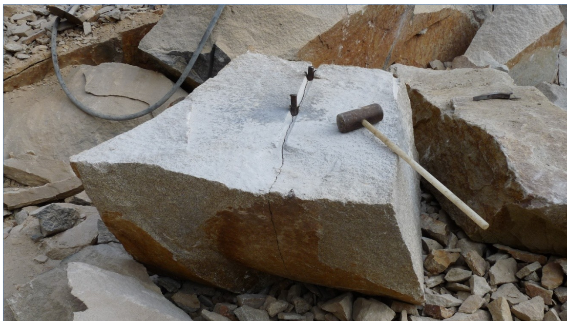
Obrázek 28: Blok č. 1 rozpojený pomocí pérových klinů.
