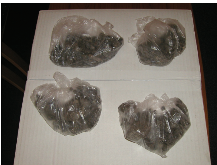
Obr. 8: Analyzované vzorky strusky odebrané z kopané sondy v podloží stavby
