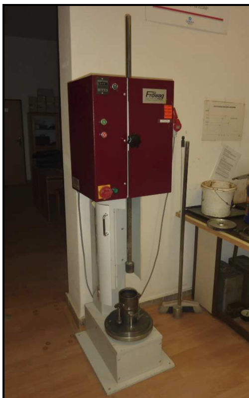
Obr. 28. Proctor modifikovaný pro zkoušku zhutnitelnosti zemin
