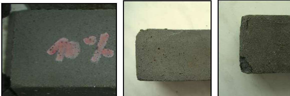
Obr. 33, 34, 35. Vývoj vlivu mrazu a rozmrazování na trámečky s 10% podílem fluidních popílků po 25, 50 a 75 cyklech
