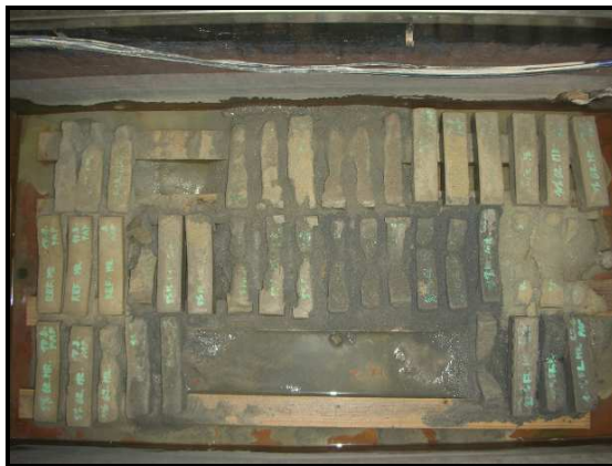
Obr. 36. Výsledek zkoušky mrazuvzdornosti po 75 cyklech
