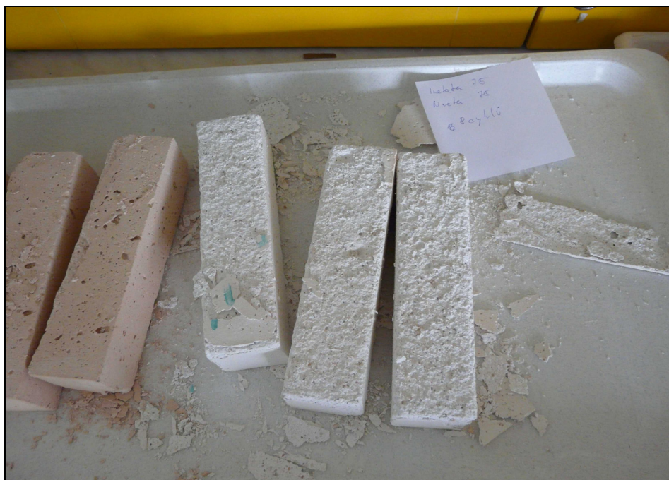
Obr. 6: Šupinovité odpadávání povrchových vrstev při zkoušce mrazuvzdornosti
