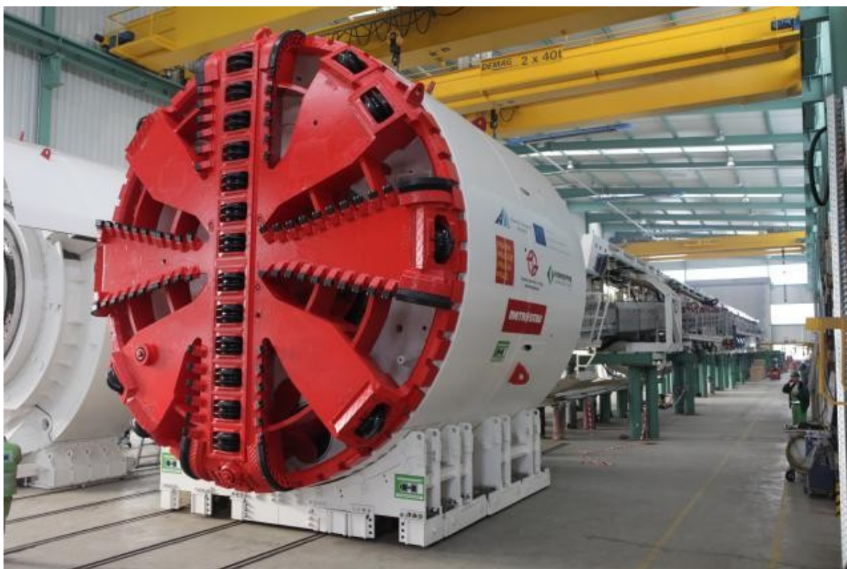
Obrázek č.4: Fotografie hotového štítu při převzetí
